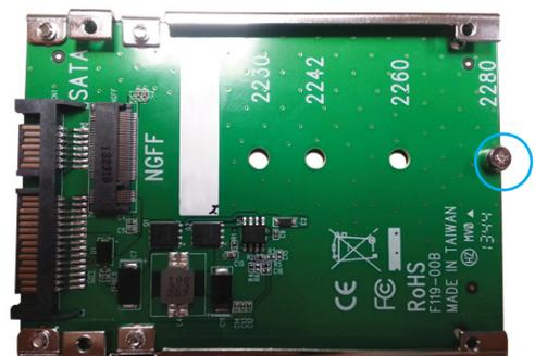
5. Deslice el Conector M.2 del SSD en el conector de adaptador.
