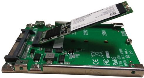
6. Presione el SSD hacia el bracket y vuelva a ajustar el tornillo que estaba posicionado coincidiendo con el agujero de montaje de su SSD.
