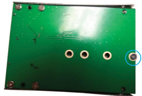
3. (Solo necesario si el soporte de instalación de la unidad requiere ser reubicado) Recoloque el bracket en la perforación que coincide con la de su unidad SSD. Recoloque el tornillo removido en la cara de la reversa utilizando un destornillador Phillips.
