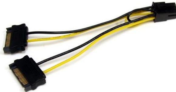
El Cable Adaptador de Alimentación SATA a Tarjeta de Video PCI Express, modelo SATPCIEXADAP, incluye un conector de alimentación PCI Express (macho) de 6 pines, así como dos conectores de alimentación SATA (macho) de 15 pines, posibilitando conectar de forma económica una tarjeta de video PCIe a conectores de alimentación Serial ATA existentes en la fuente de poder de una computadora, eliminando de esta forma la necesidad de actualizarla con motivo de su incompatibilidad con la tarjeta.
