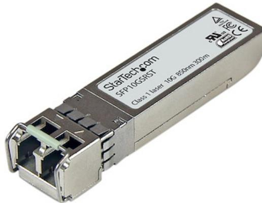
El modelo SFP10GSRST es un módulo transceptor por fibra óptica compatible con Cisco SFP-10G-SR, diseñado, programado y probado para su funcionamiento con enrutadores y conmutadores de la marca Cisco®. Ofrece conectividad 10GbE confiable a través de cable de fibra óptica para redes compatibles con 10GBASE-SR, con una distancia máxima de hasta 300m.
