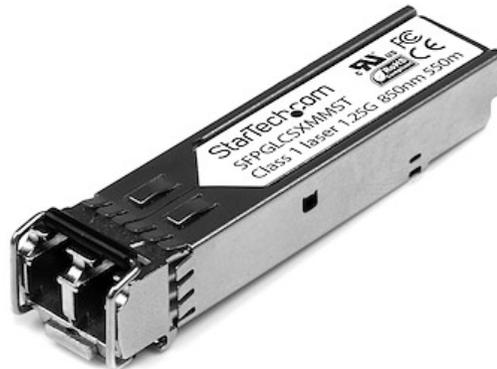
El modelo SFPGLCSXMMST es un módulo transceptor por fibra óptica, diseñado, programado y probado para su funcionamiento con enrutadores y conmutadores de la marca Cisco®. Ofrece conectividad confiable a 1GbE (1000 Mbps) a través de cableado de fibra, para redes compatibles con 1000BASE-SX, a una distancia máxima de hasta 550m.
