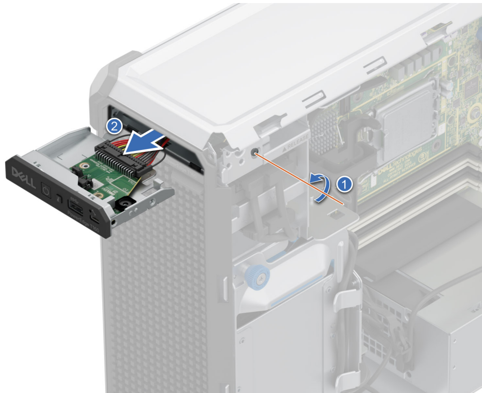
Ilustración 66. Extracción de la canastilla del panel de control
