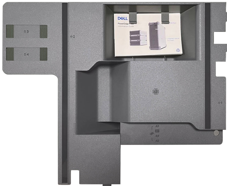
Ilustración 8. Cubierta para flujo de aire con SIB
