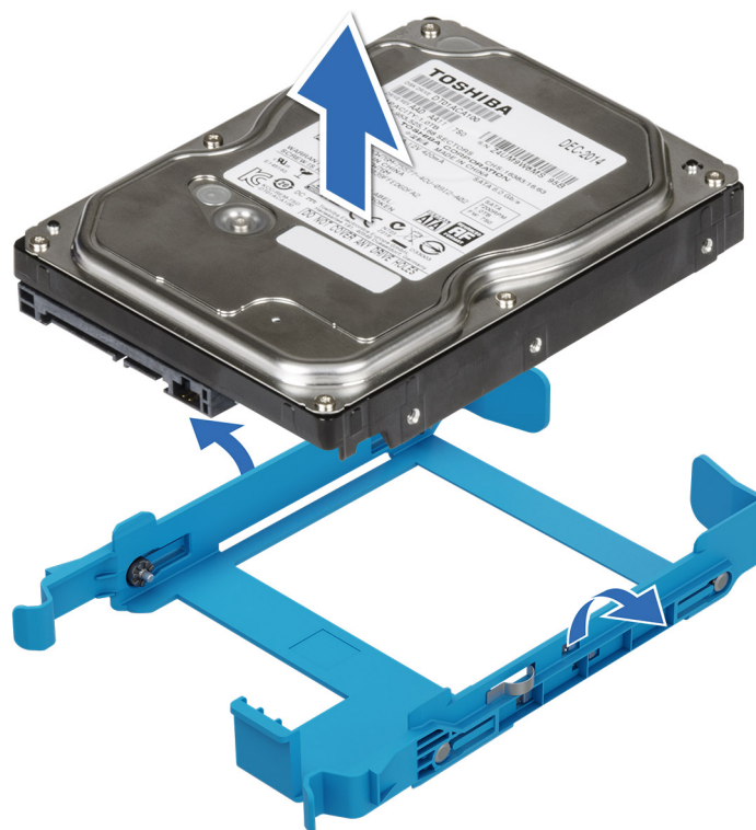
Ilustración 24. Extracción de una unidad del portaunidades
