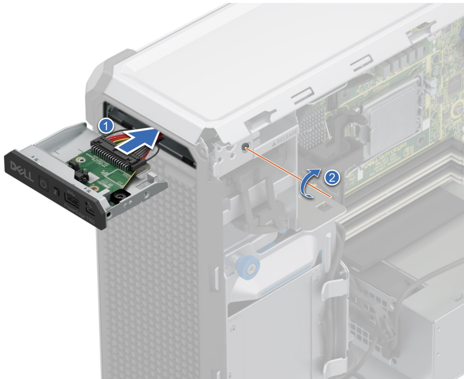
Ilustración 69. Instalación de la canastilla del panel de control
