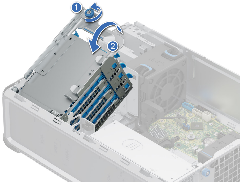
Ilustración 18. Extracción de una unidad de la caja de unidades
