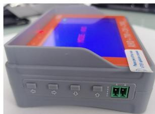
El probador incorpora el protocolo de control PTZ Pelco-D, /P etc., a través de su interfaz RS485 propia.
