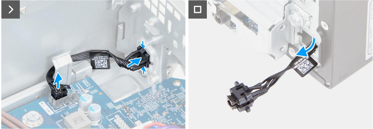
**Ilustración 43. Extracción del botón de encendido**
