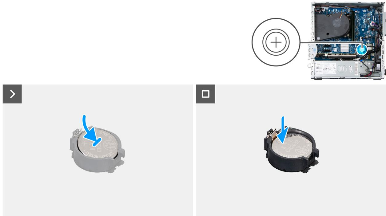
**Ilustración 13. Instalación de la batería de tipo botón**
