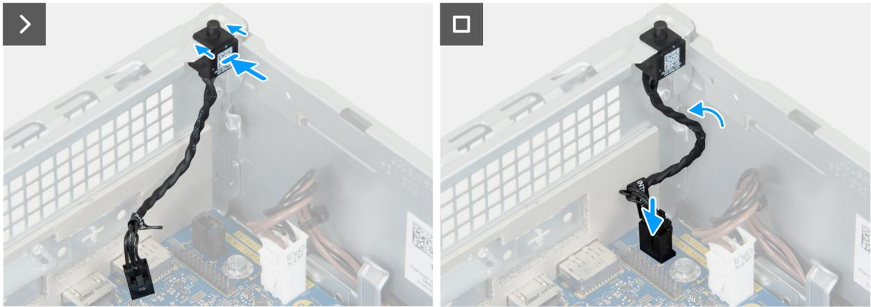
**Ilustración 42. Instalación del switch de intrusión**
