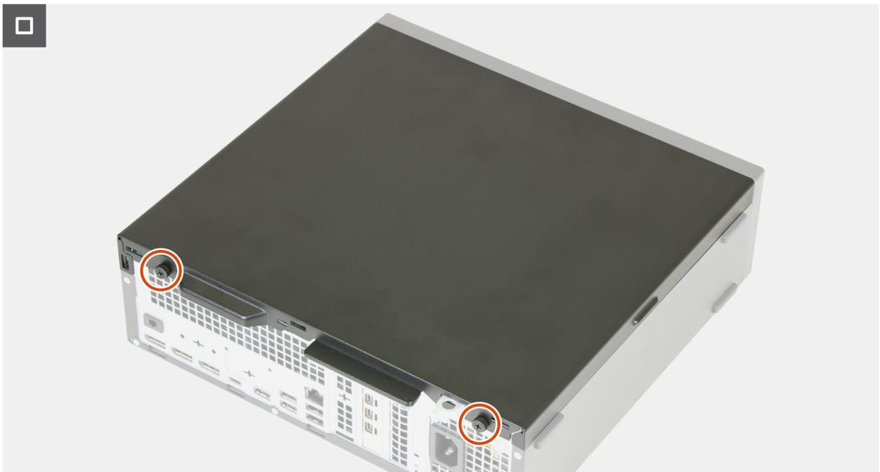
Ilustración 9. Instalación de la cubierta lateral
