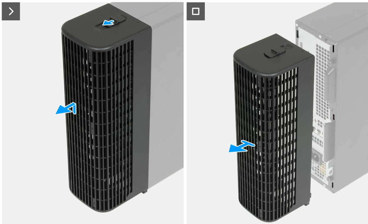
Ilustración 4. Extracción de la cubierta de cables
