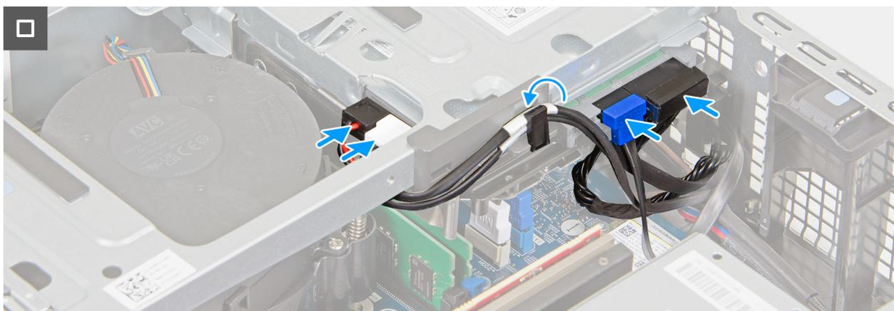
**Ilustración 38. Instalación del compartimiento de la unidad**
