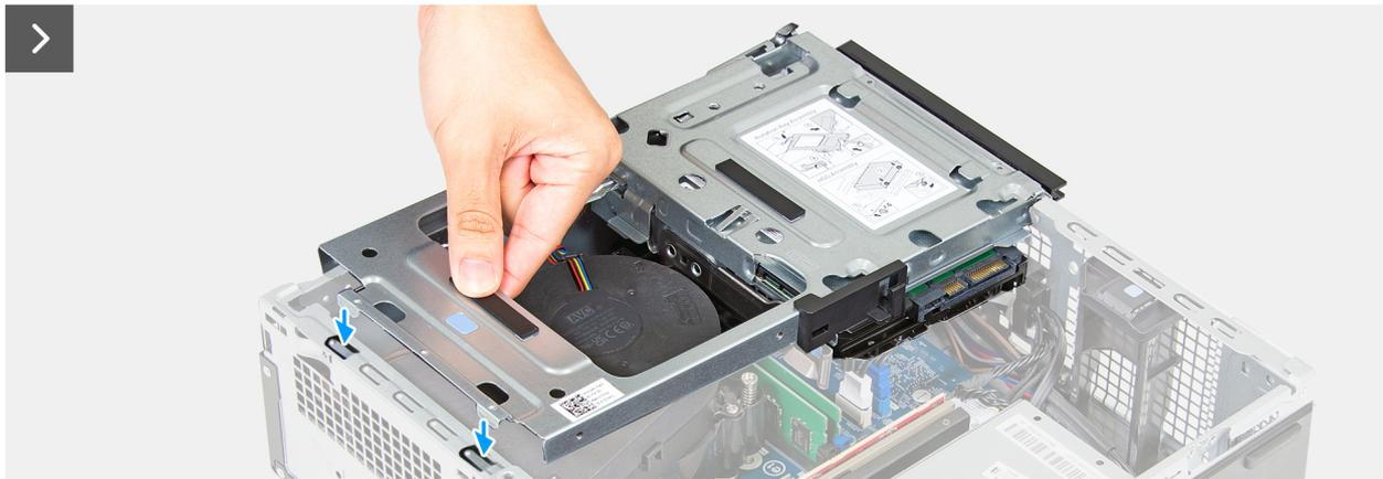
**Ilustración 37. Instalación del compartimiento de la unidad**
