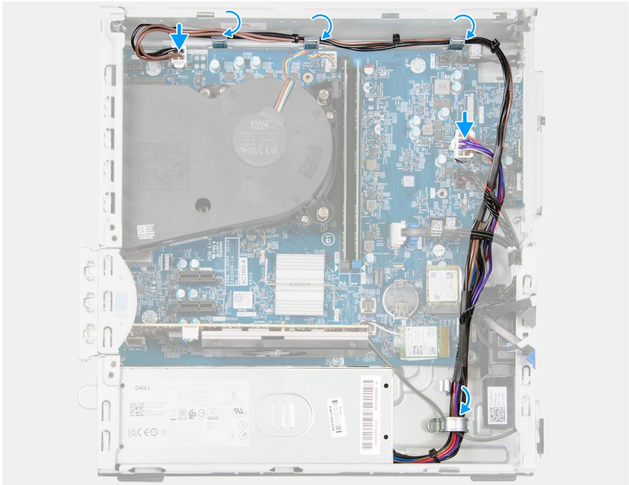
**Ilustración 50. Instalación de la fuente de alimentación**
