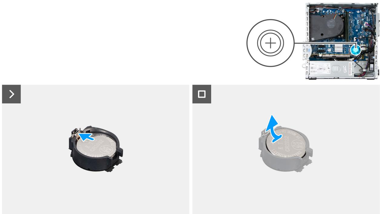
**Ilustración 12. Extracción de la batería de tipo botón**
