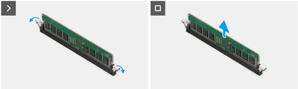
Ilustración 20. Extracción de un módulo de memoria
