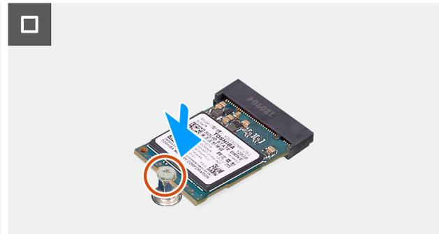
**Ilustración 23. Instalación de la unidad de estado sólido M.2 2230**
