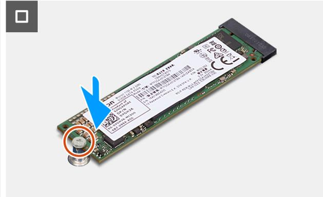
**Ilustración 25. Instalación de la unidad de estado sólido M.2 2280**
