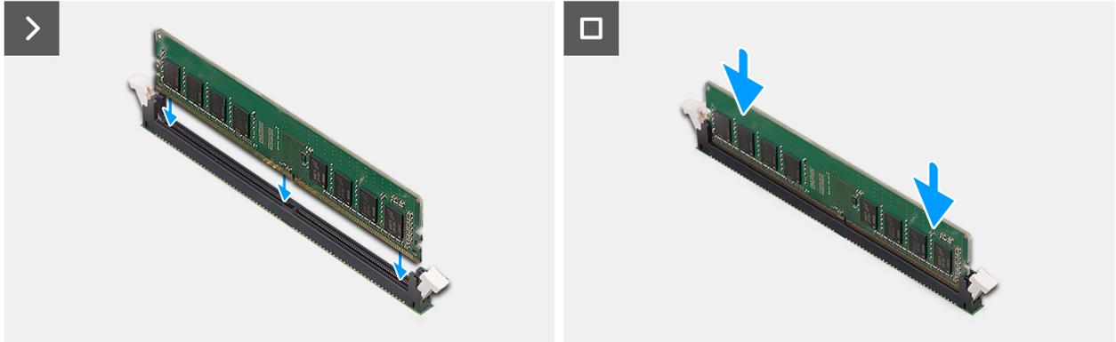
**Ilustración 21. Instalación del módulo de memoria**
