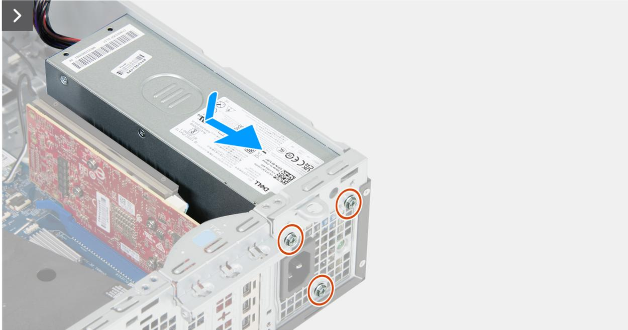
**Ilustración 49. Instalación de la fuente de alimentación**
