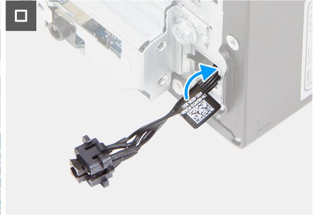
**Ilustración 44. Instalación del botón de encendido**
