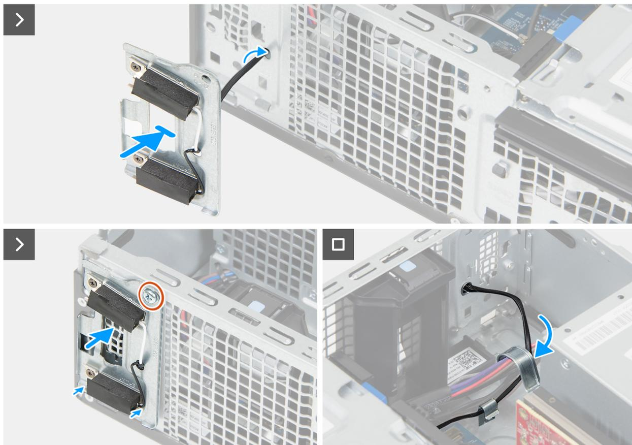
**Ilustración 46. Instalación de los módulos de la antena**
