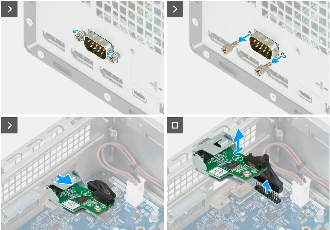
Ilustración 56. Cómo extraer el módulo de puerto serial
