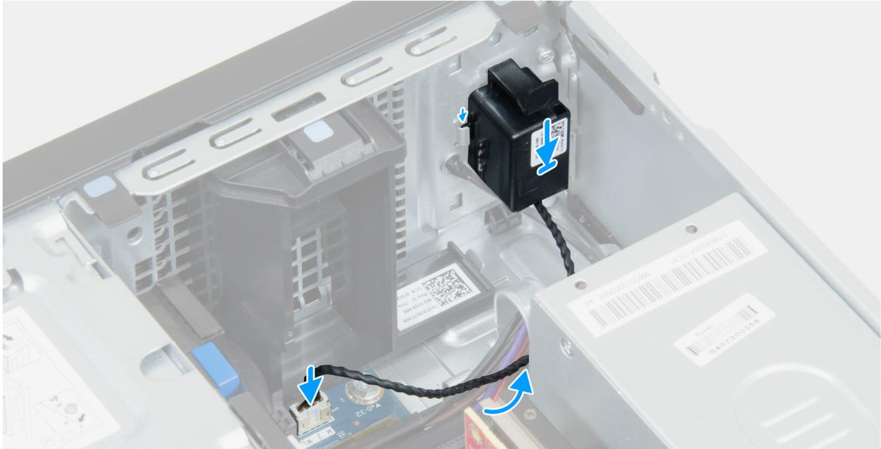
**Ilustración 19. Instalación del altavoz interno**
