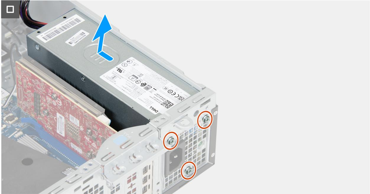
**Ilustración 48. Extracción de la fuente de alimentación**
