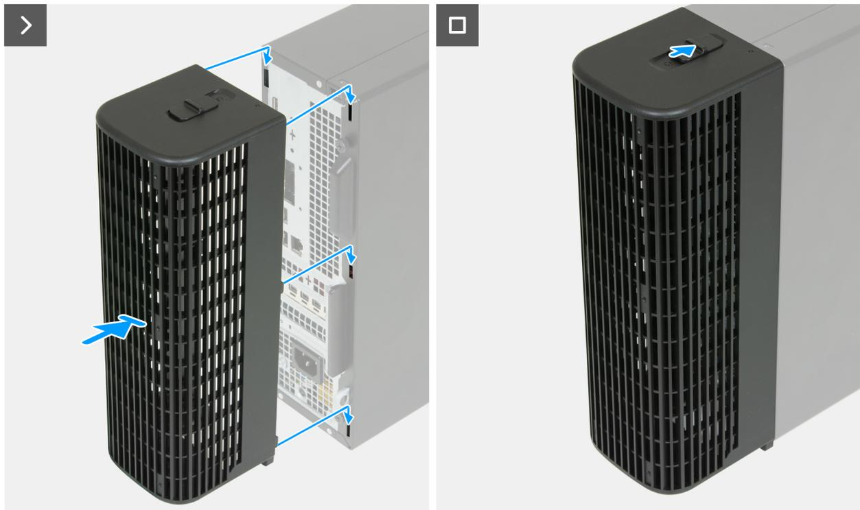
**Ilustración 5. Instalación de la cubierta de cables**
