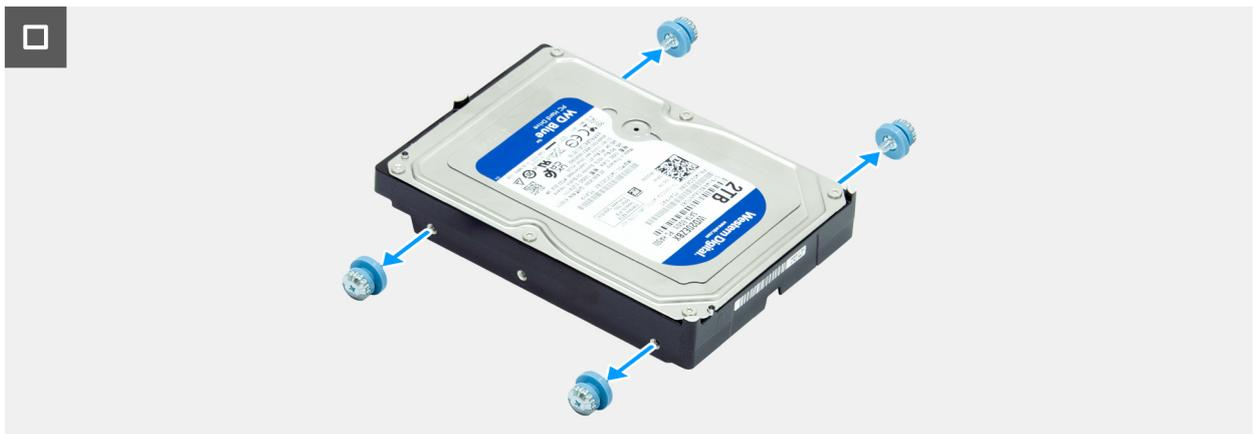
**Ilustración 39. Extracción del disco duro**
