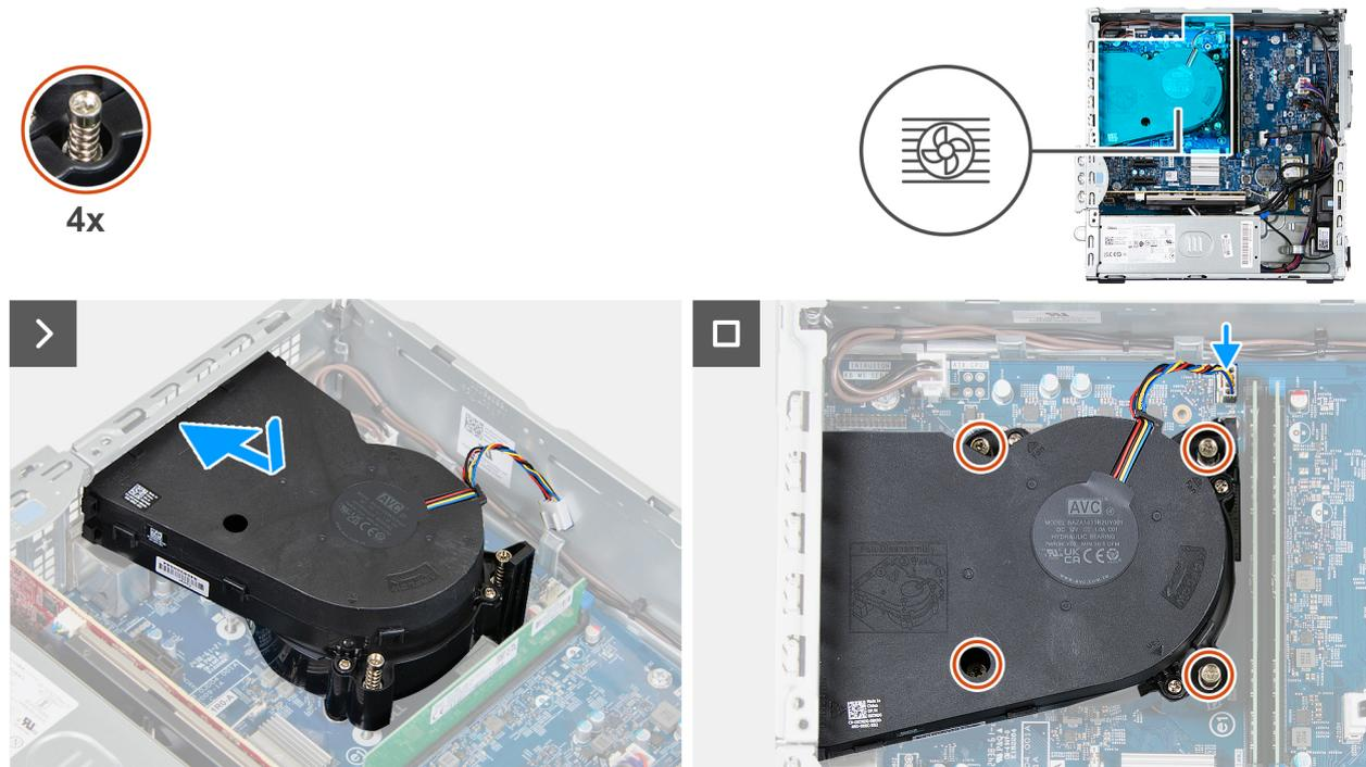
**Ilustración 52. Instalación del ensamblaje del disipador de calor y el ventilador del procesador**
