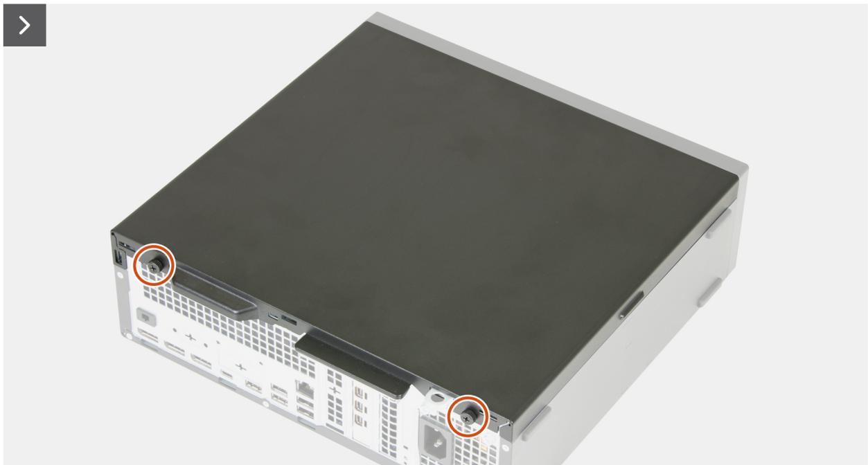
Ilustración 6. Extracción de la cubierta lateral
