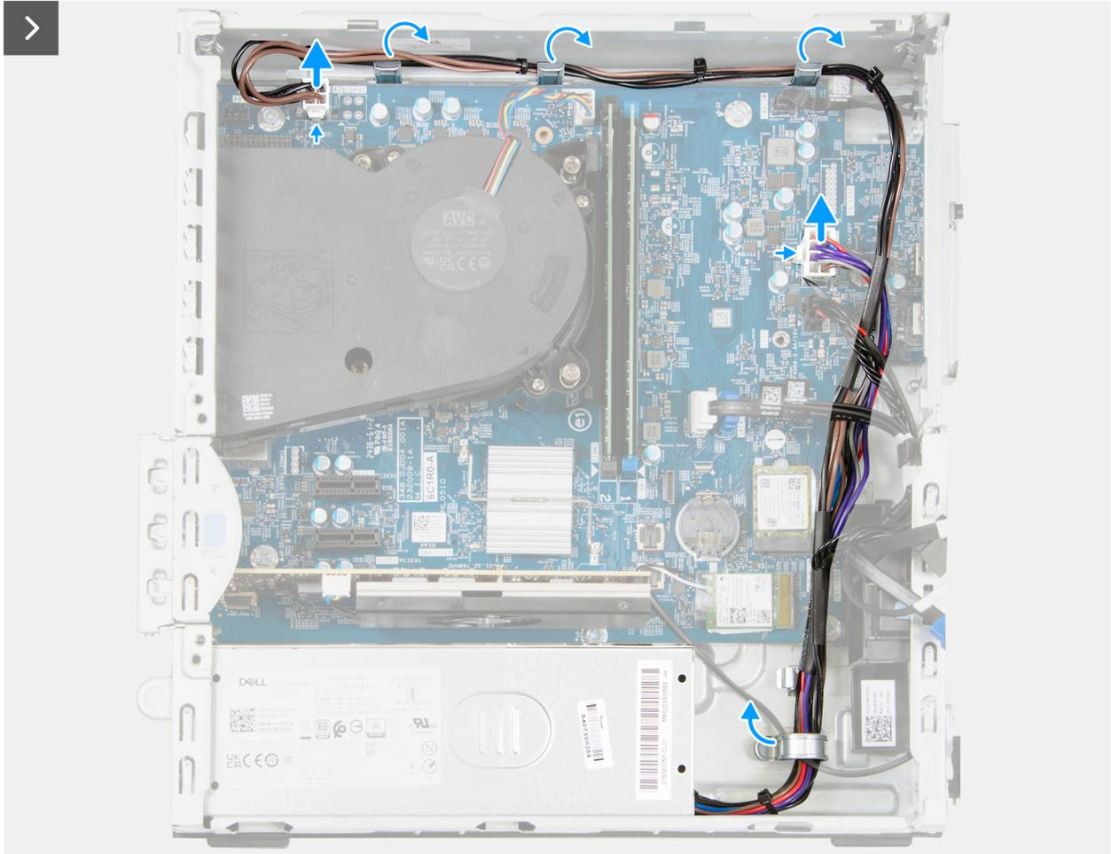
Ilustración 47. Extracción de la fuente de alimentación
