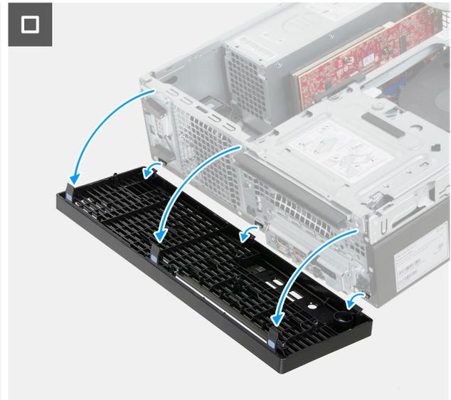
**Ilustración 16. Extracción de la cubierta frontal**
