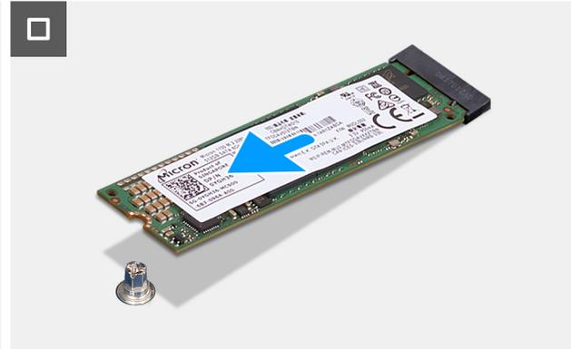
Ilustración 24. Extracción de la unidad de estado sólido M.2 2280
