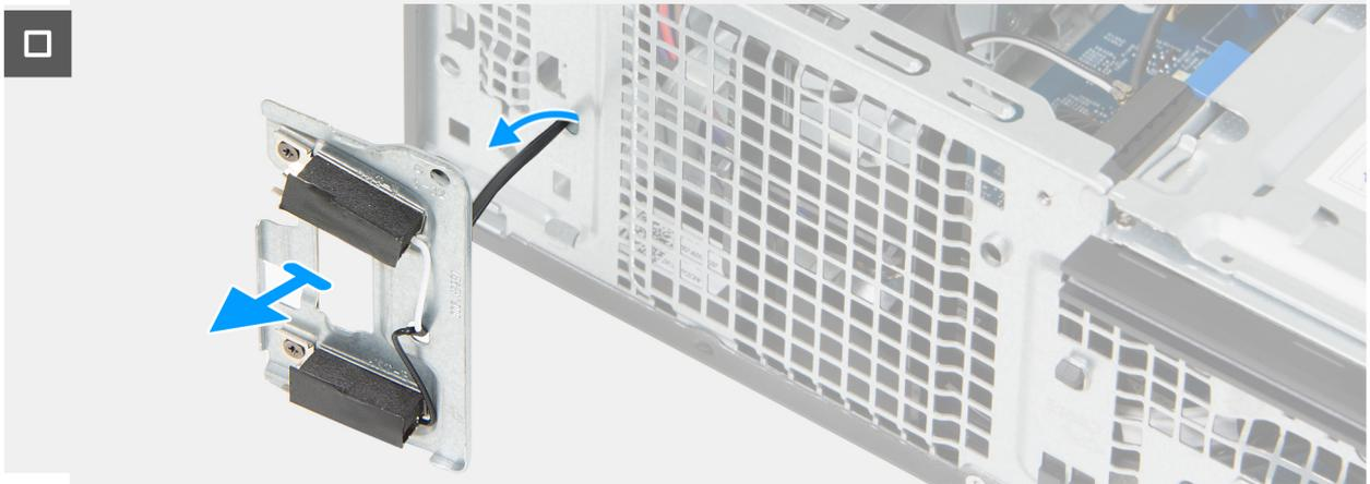
**Ilustración 45. Extracción de los módulos de la antena**
