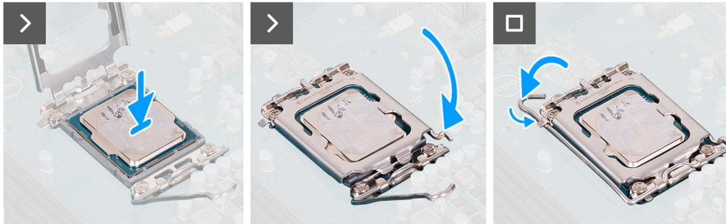
**Ilustración 60. Instalación del procesador**
