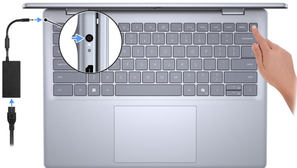
**Ilustración 8. Conecte el adaptador de alimentación y presione el botón de encendido.**
