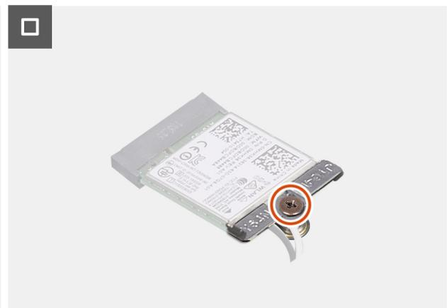
Ilustración 29. Instalación de la tarjeta inalámbrica
