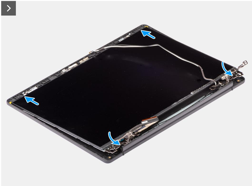
Ilustración 84. Instalación de los tornillos
