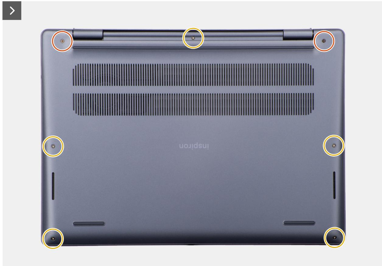
Ilustración 15. Extracción de la cubierta de la base
