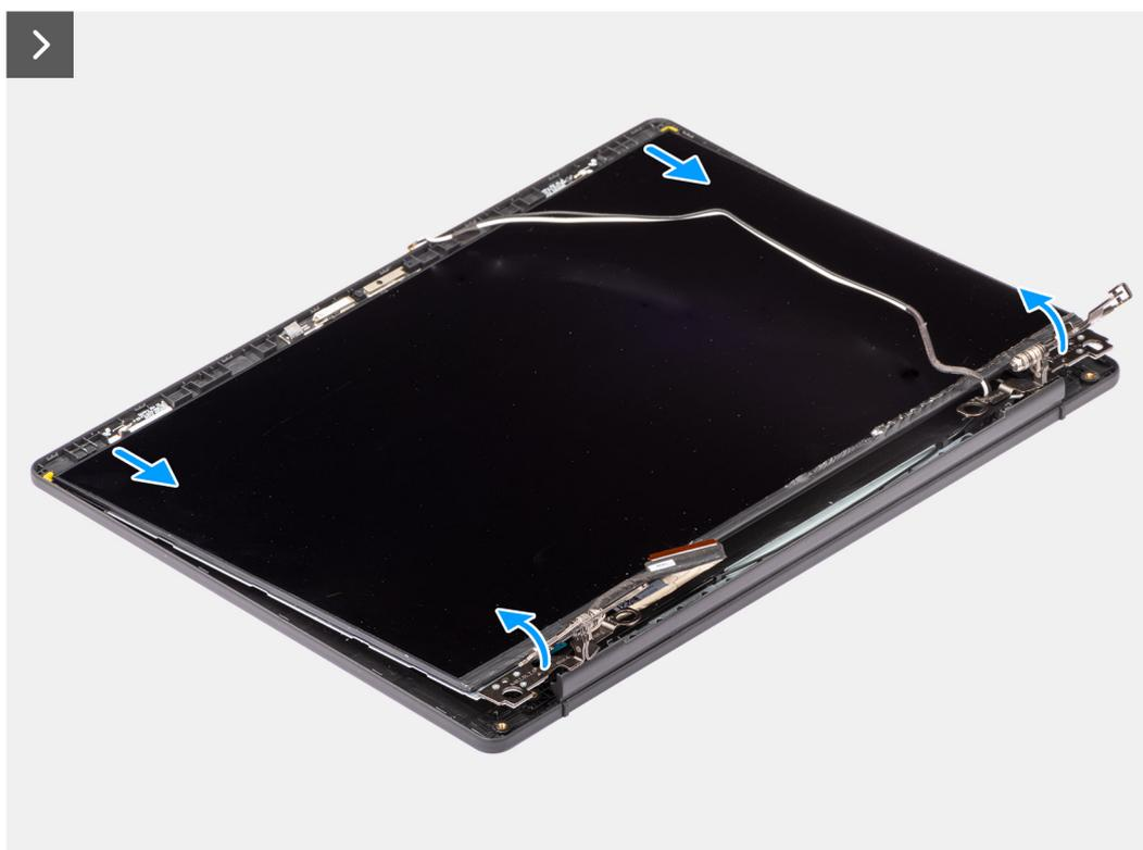
Ilustración 80. Extracción del panel de pantalla
