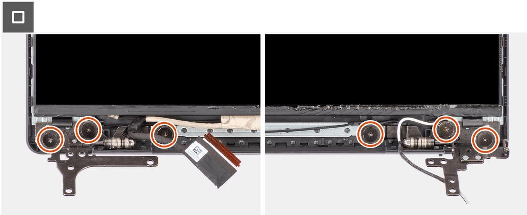
**Ilustración 86. Instalación del panel de pantalla**
