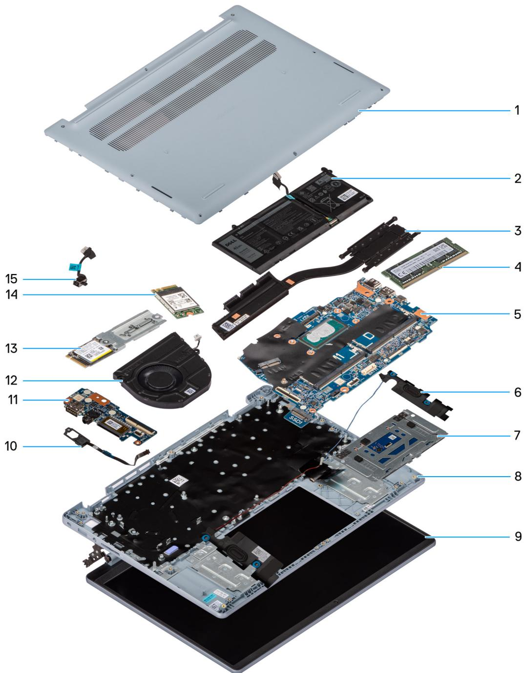
**Ilustración 9. Componentes principales para computadoras que se envían con un chasis de plástico**
