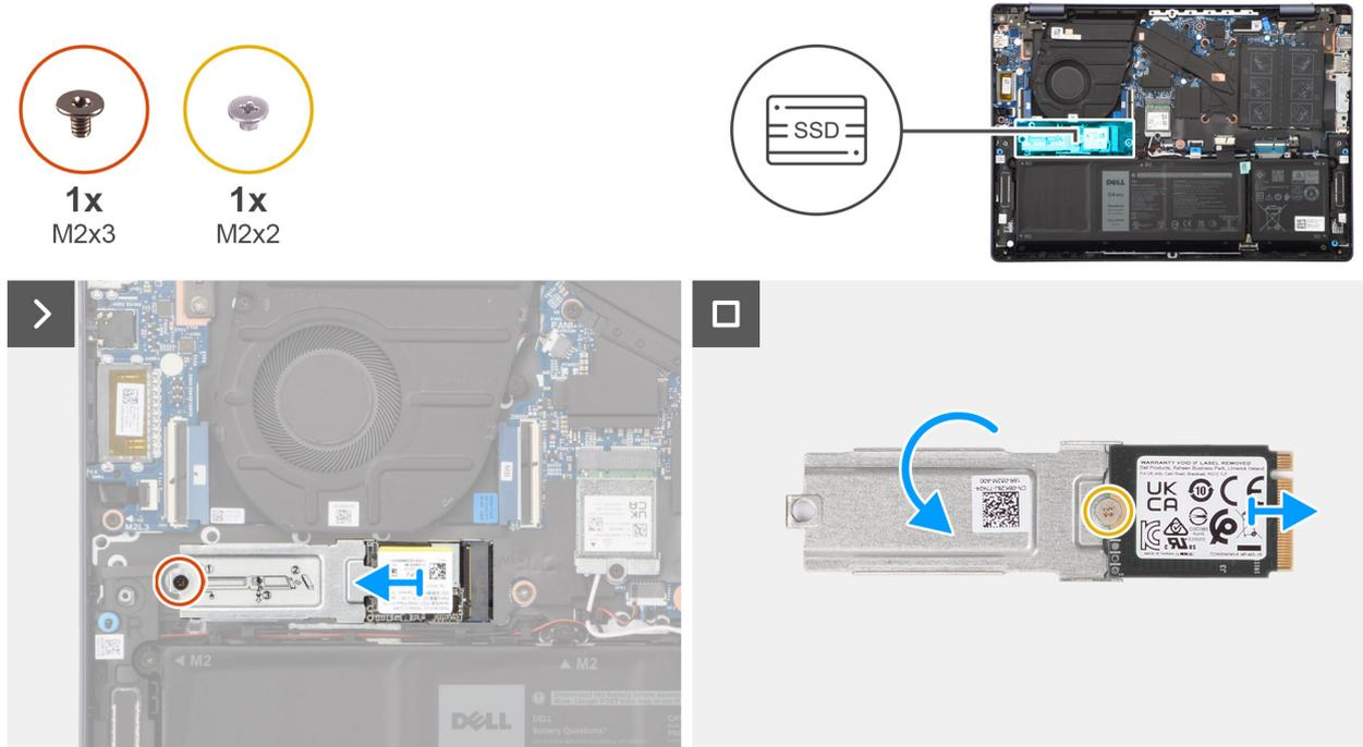
**Ilustración 26. Extracción de la unidad de estado sólido**
