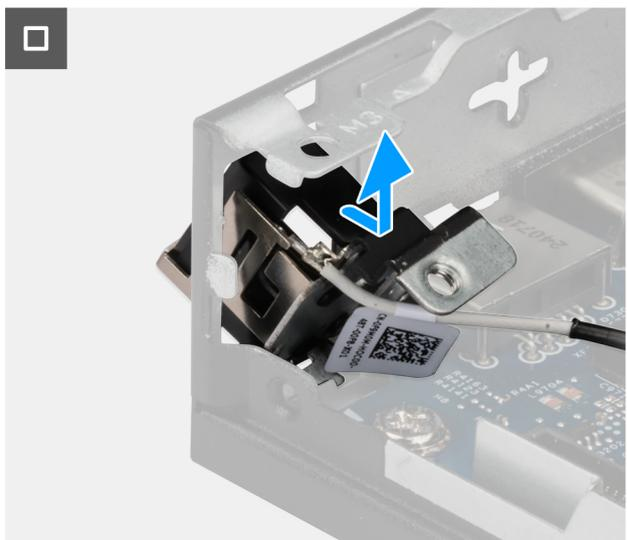
Ilustración 63. Extracción del módulo de la antena (cable blanco)
