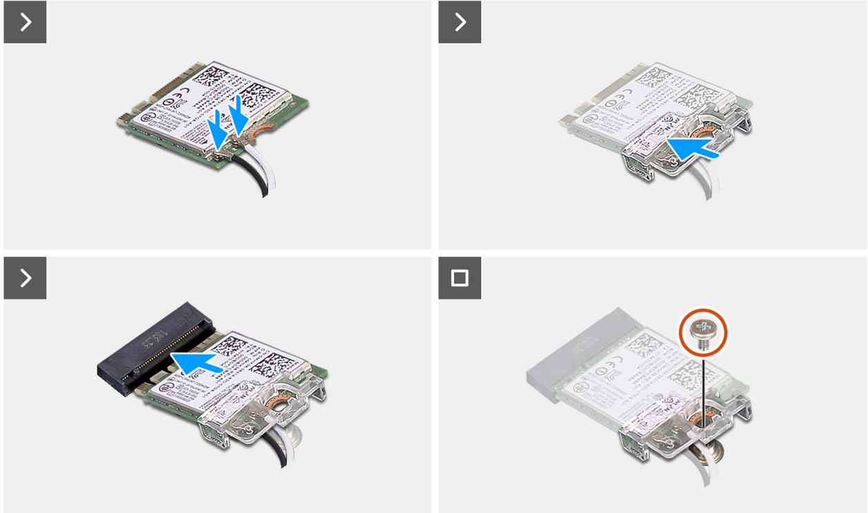
**Ilustración 27. Instalación de la tarjeta inalámbrica**
