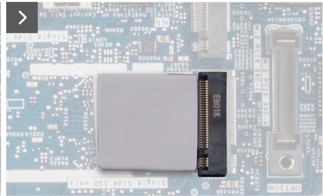
Ilustración 20. Instalación de la unidad de estado sólido M.2 2280
