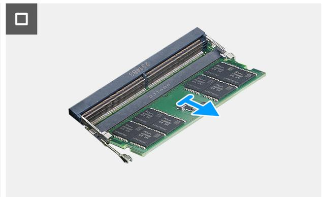
**Ilustración 32. Extracción del módulo de memoria**
