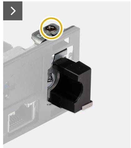
Ilustración 62. Extracción del módulo de la antena (cable blanco)
