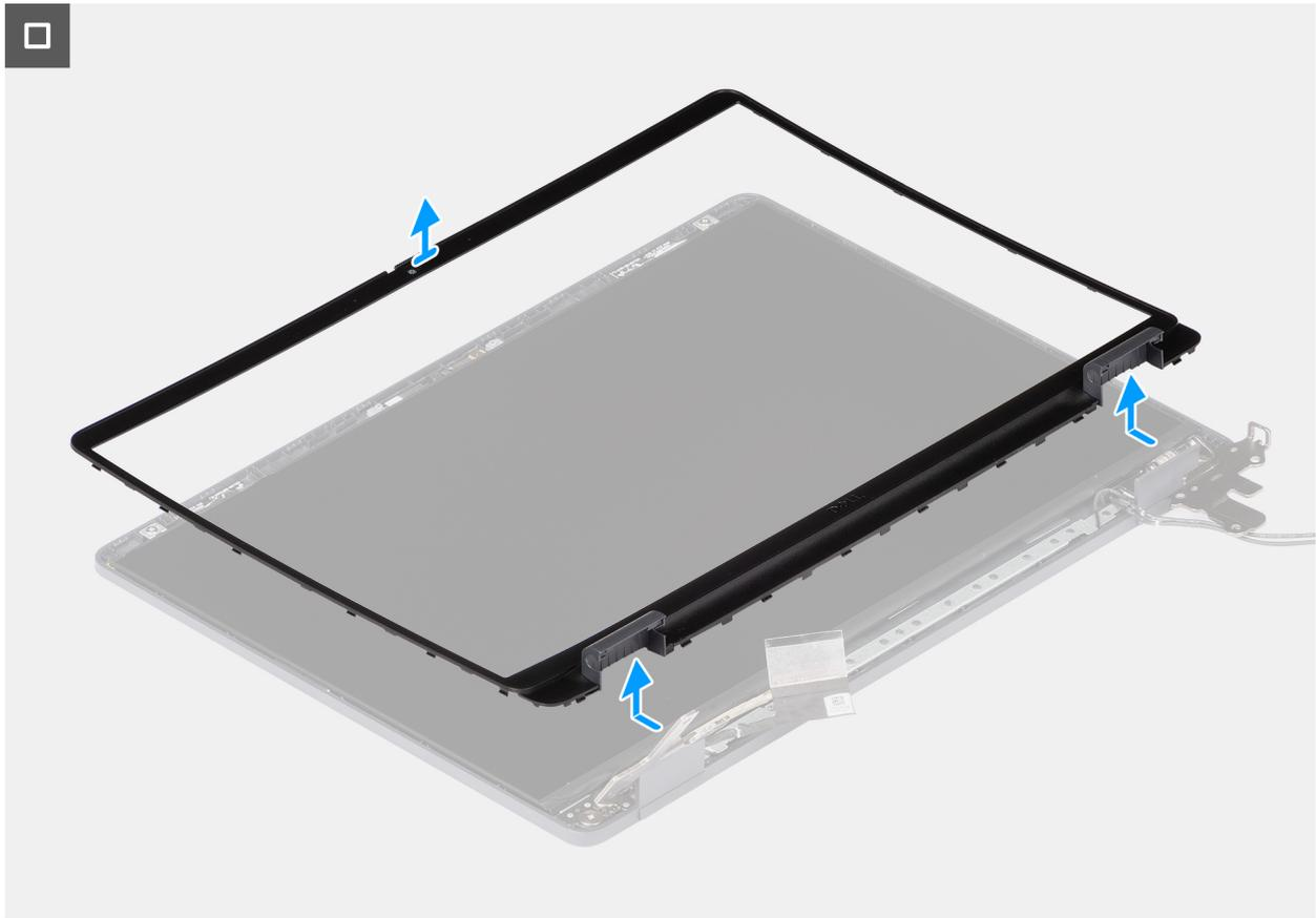
**Ilustración 102. Extracción del embellecedor de la pantalla**
