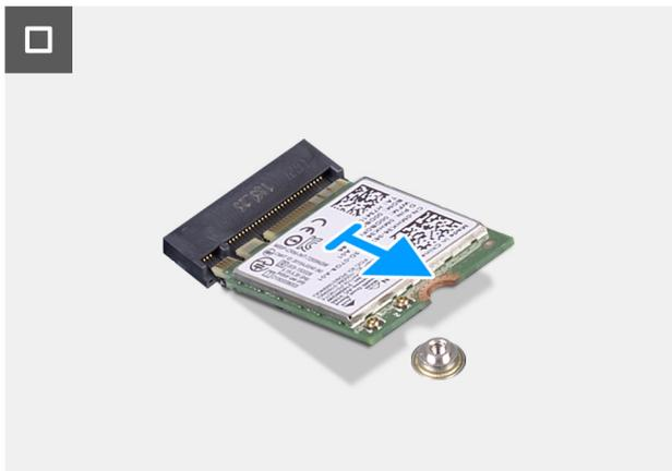
**Ilustración 25. Extracción de la tarjeta inalámbrica**
