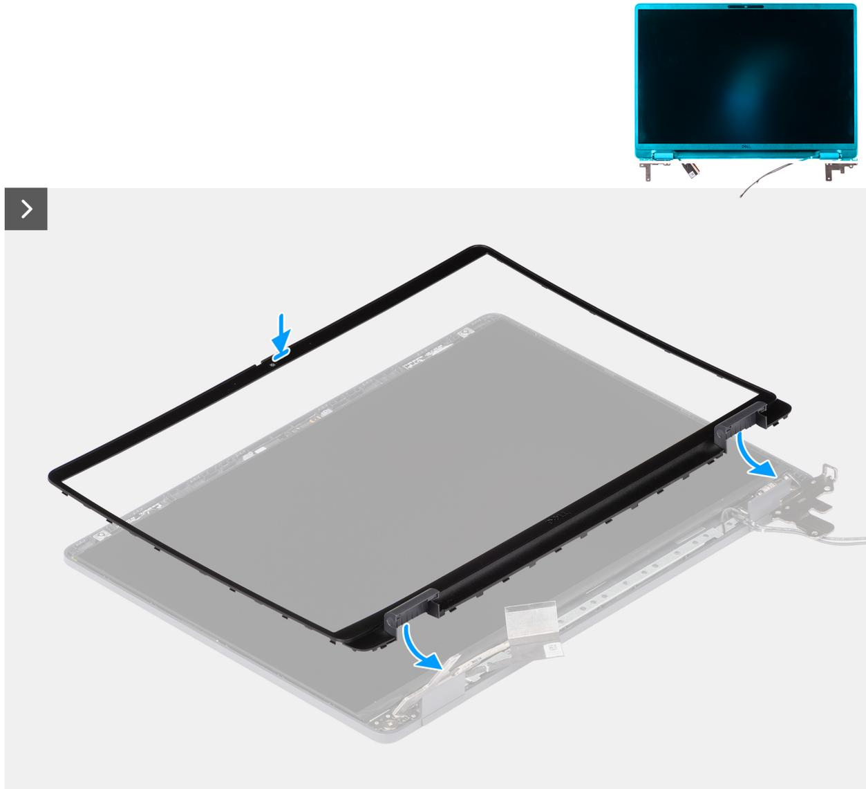
**Ilustración 103. Instalación del bisel de la pantalla**
