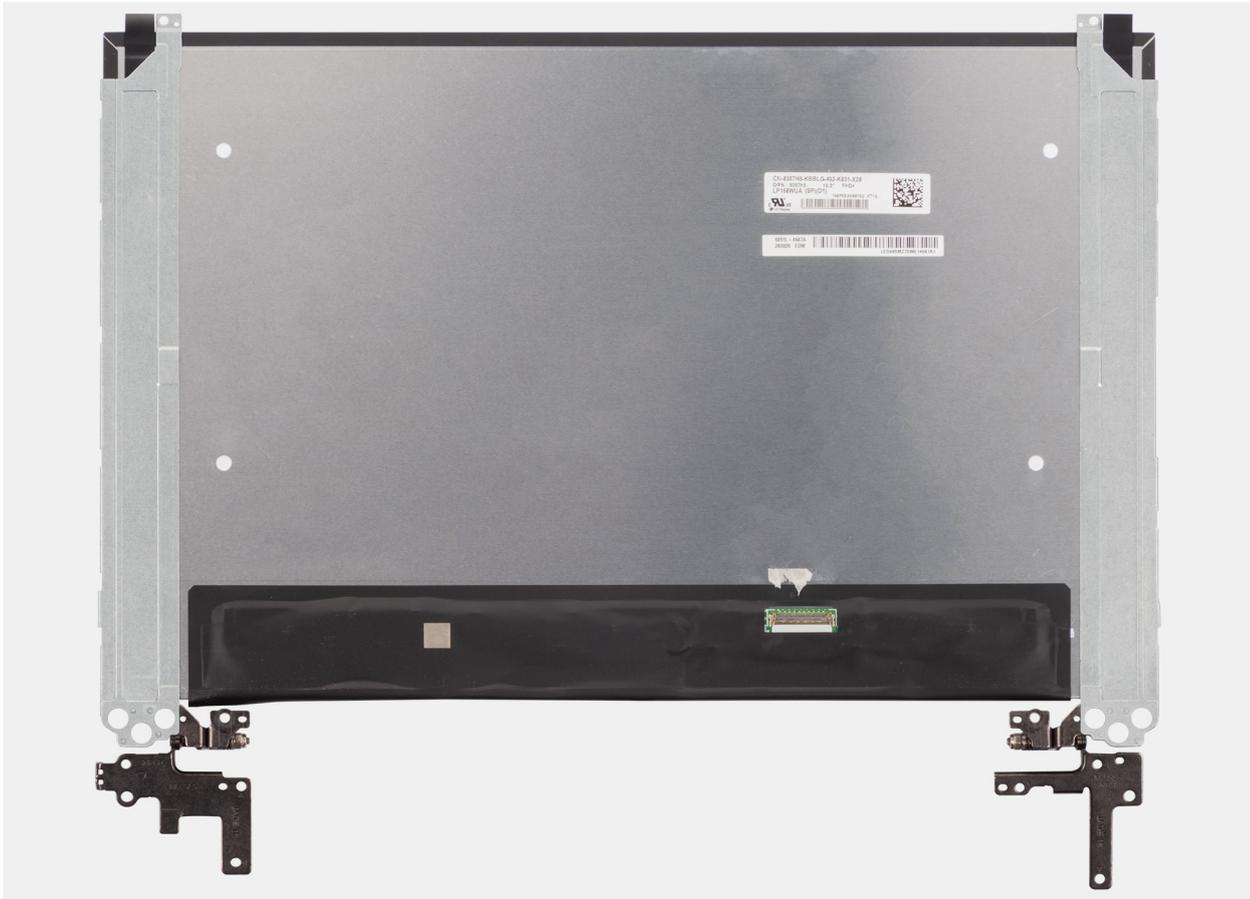
1. Quite los seis tornillos (M2.5x2.5) y los cuatro tornillos (M2.5x3.5) que fijan las bisagras izquierda y derecha a la cubierta posterior de la pantalla.
