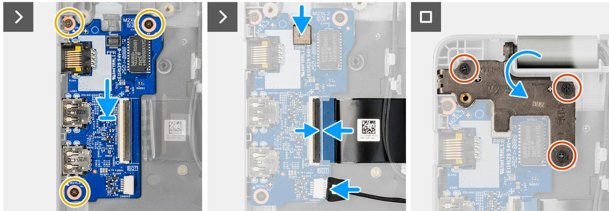
**Ilustración 52. Instalación de la placa de I/O**
