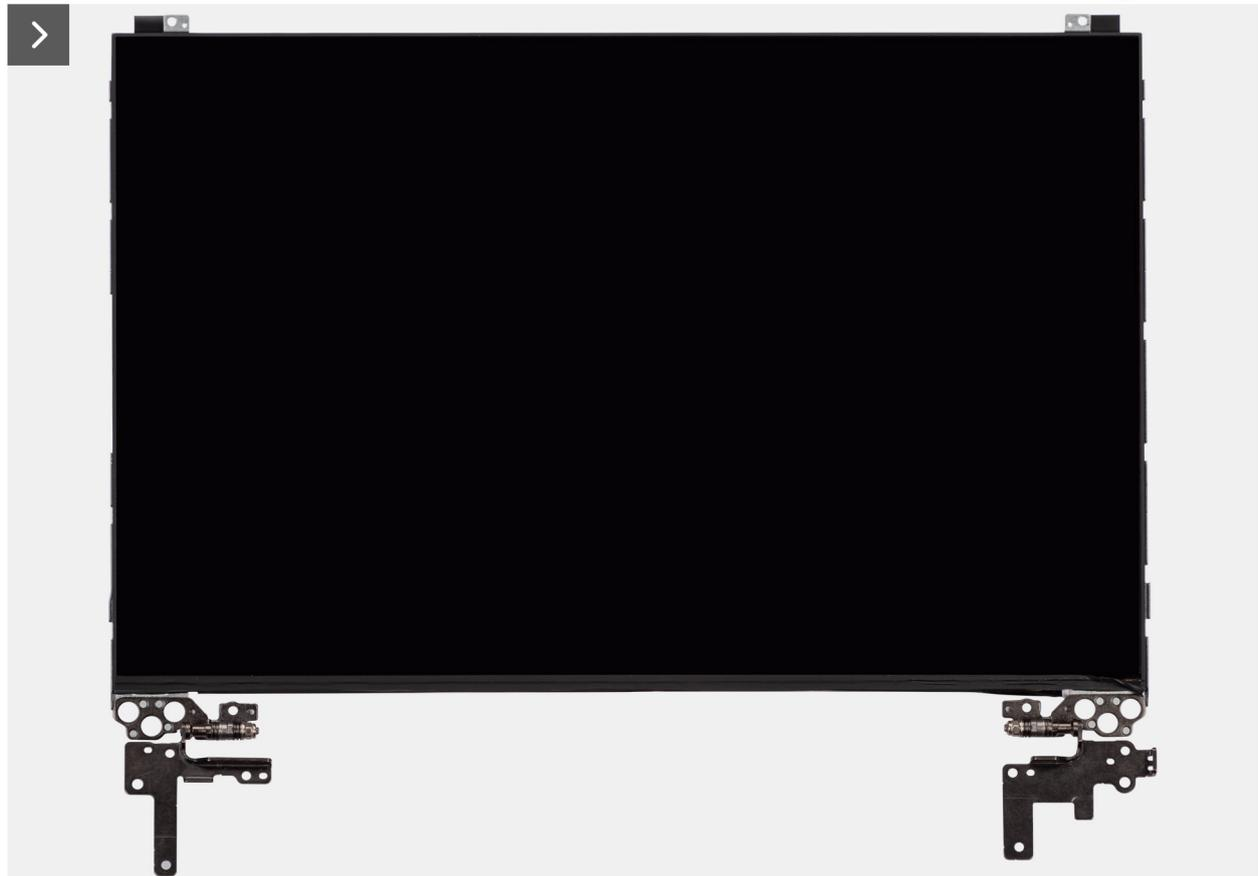
**Ilustración 109. Instalación del ensamblaje del panel de pantalla**
