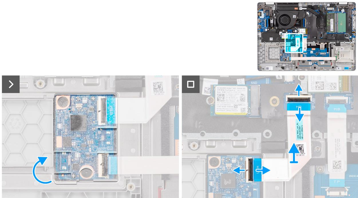
**Ilustración 35. Extracción del FPC de la placa USH**
