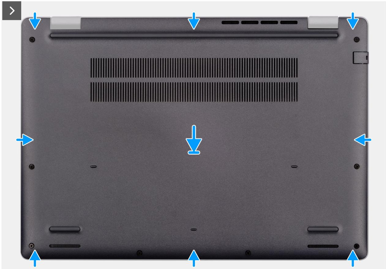
**Ilustración 15. Instalación de la cubierta de la base**
