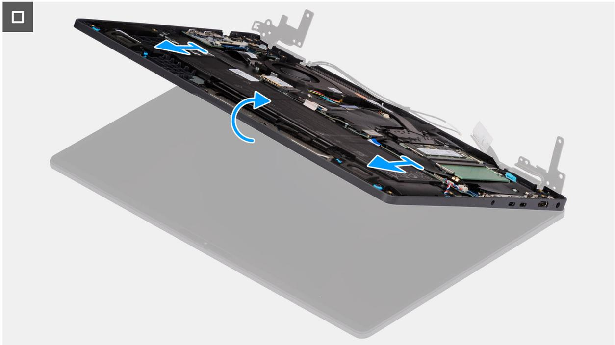
**Ilustración 94. Extracción del ensamblaje de la pantalla**
