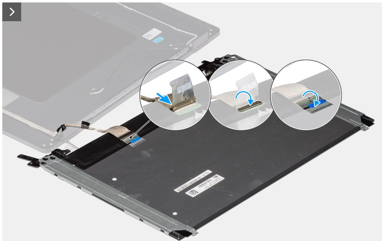
**Ilustración 110. Instalación del ensamblaje del panel de pantalla**
