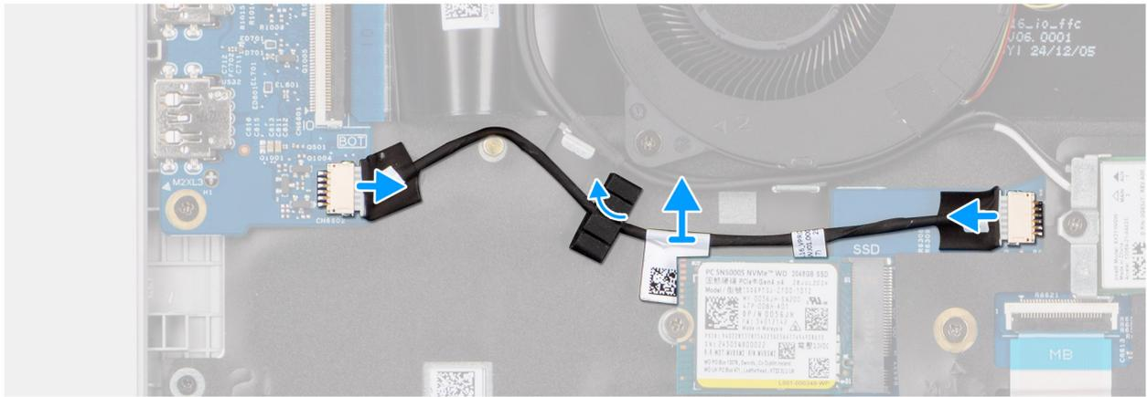
**Ilustración 47. Extracción del cable de vPro**
