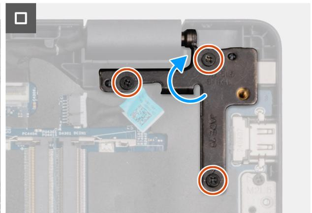
Ilustración 93. Extracción del ensamblaje de la pantalla
