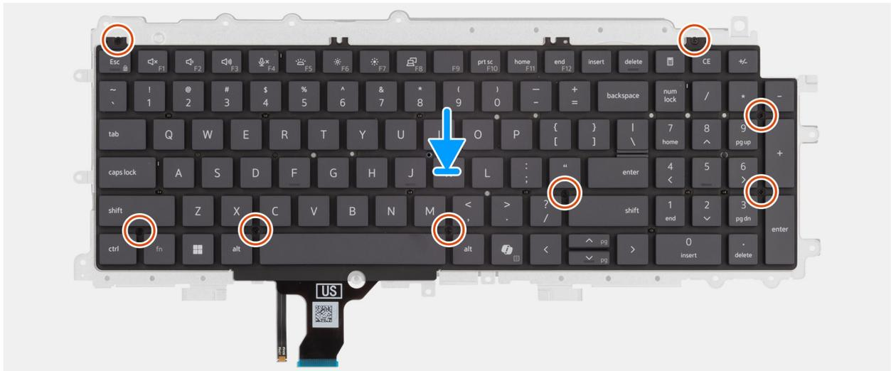
**Ilustración 88. Instalación de la placa de soporte del teclado**
