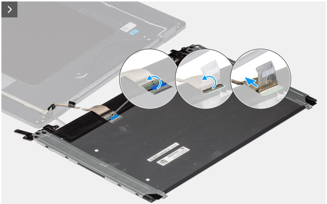
Ilustración 107. Extracción del ensamblaje del panel de pantalla
