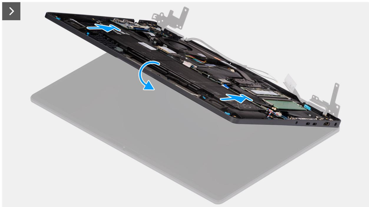
Ilustración 96. Instalación del ensamblaje de la pantalla
