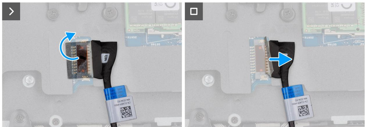
**Ilustración 13. Desconexión del cable de la batería**
