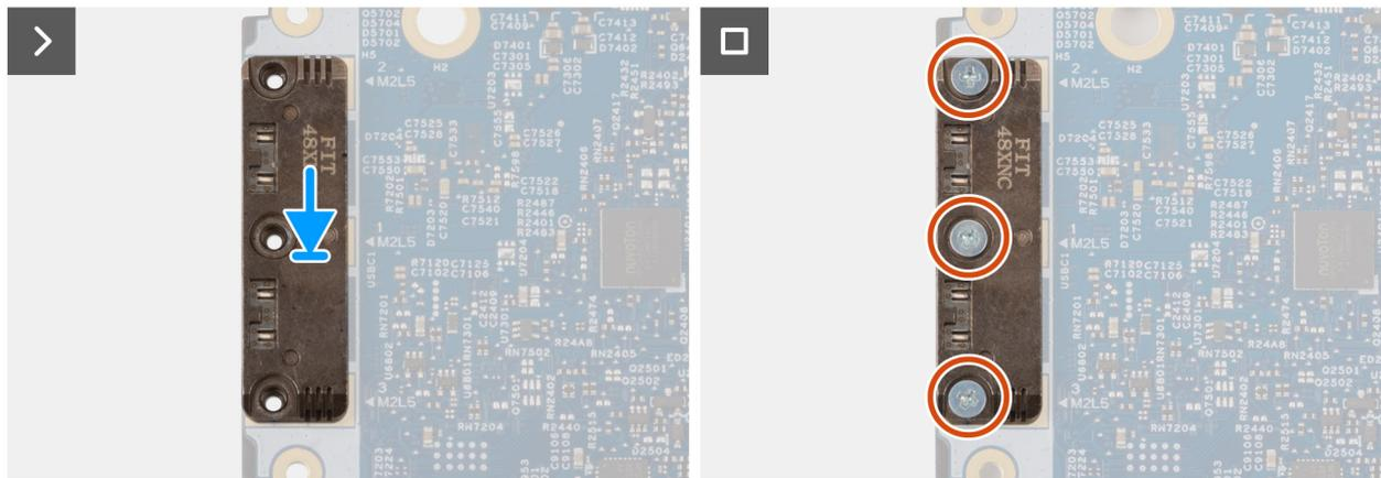
**Ilustración 76. Instalación del módulo USB Type-C**
