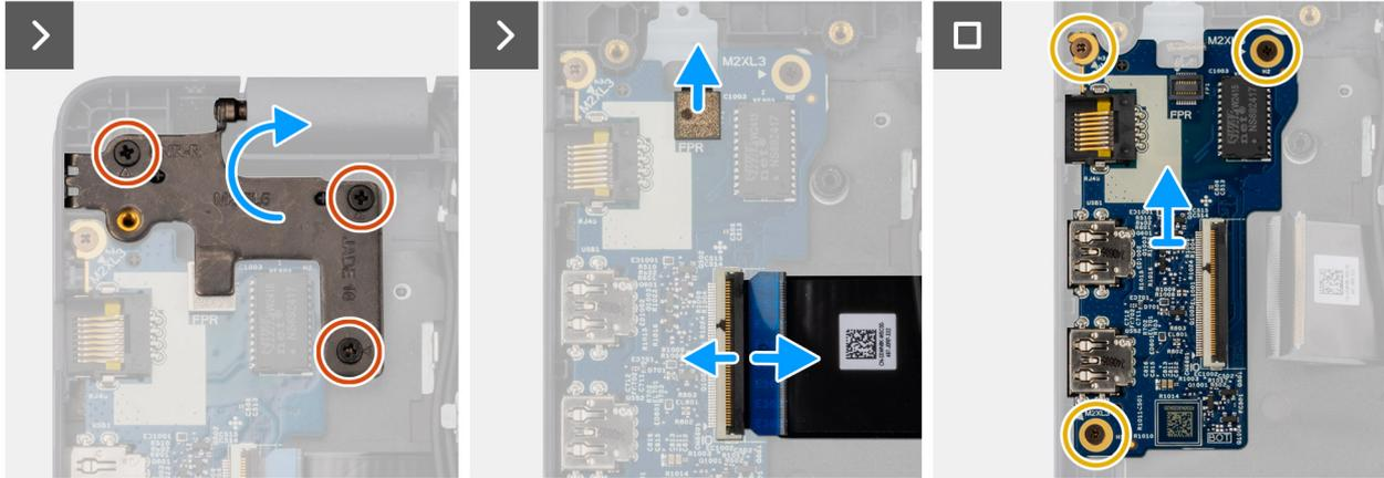
**Ilustración 49. Extracción de la placa de I/O**
