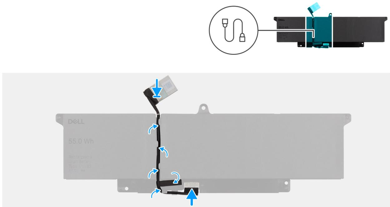
**Ilustración 20. Instalación del cable de la batería**
