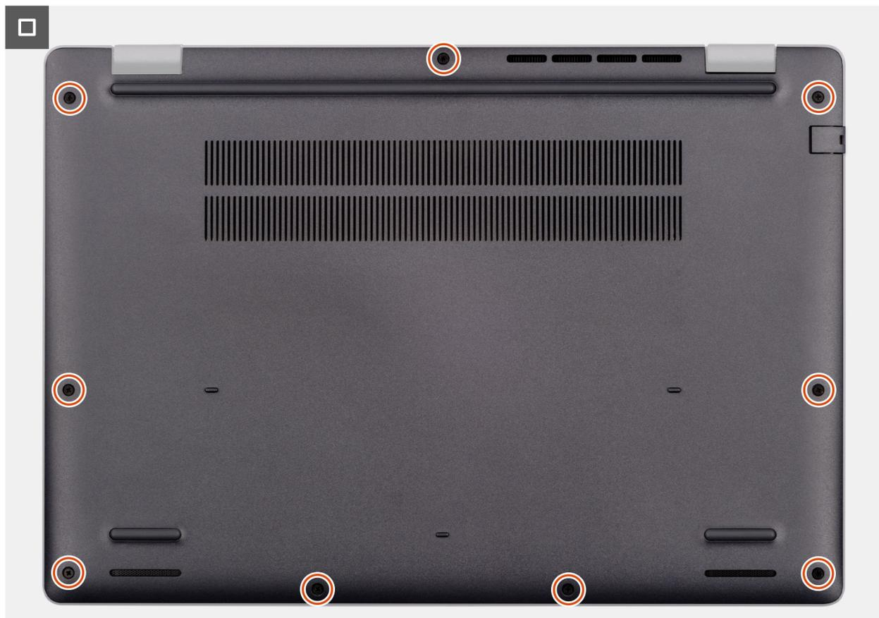
**Ilustración 16. Instalación de la cubierta de la base**
