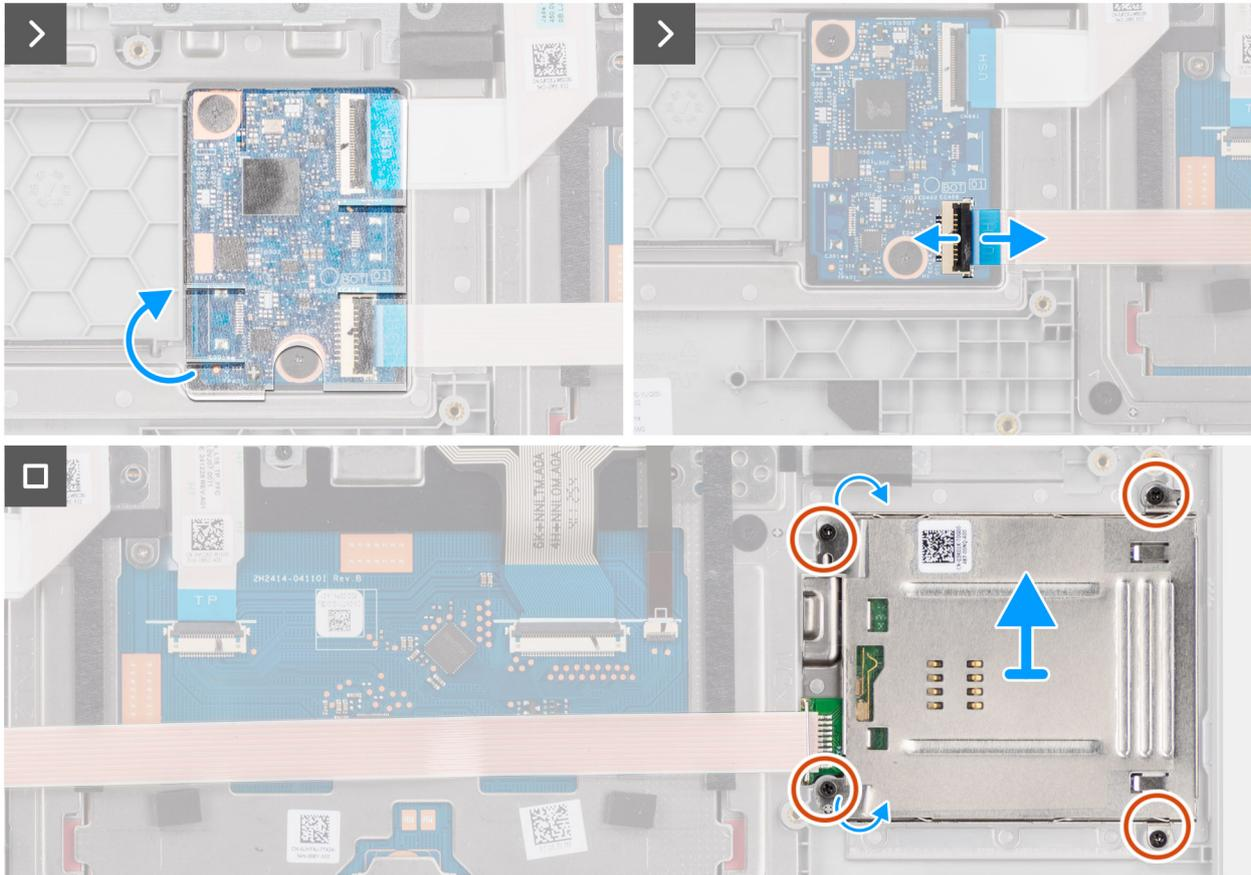
**Ilustración 39. Extracción del lector de tarjetas inteligentes**
