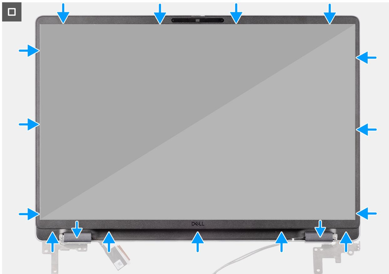
**Ilustración 104. Instalación del bisel de la pantalla**
