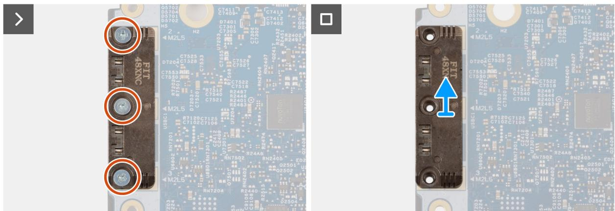
**Ilustración 77. Extracción del módulo USB Type-C**
