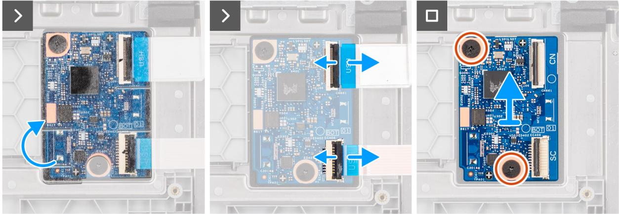
**Ilustración 37. Extracción de la placa USH**
