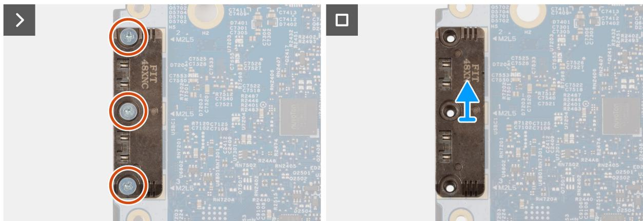
Ilustración 75. Extracción del módulo USB Type-C
