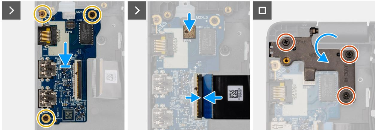
**Ilustración 50. Instalación de la placa de I/O**
