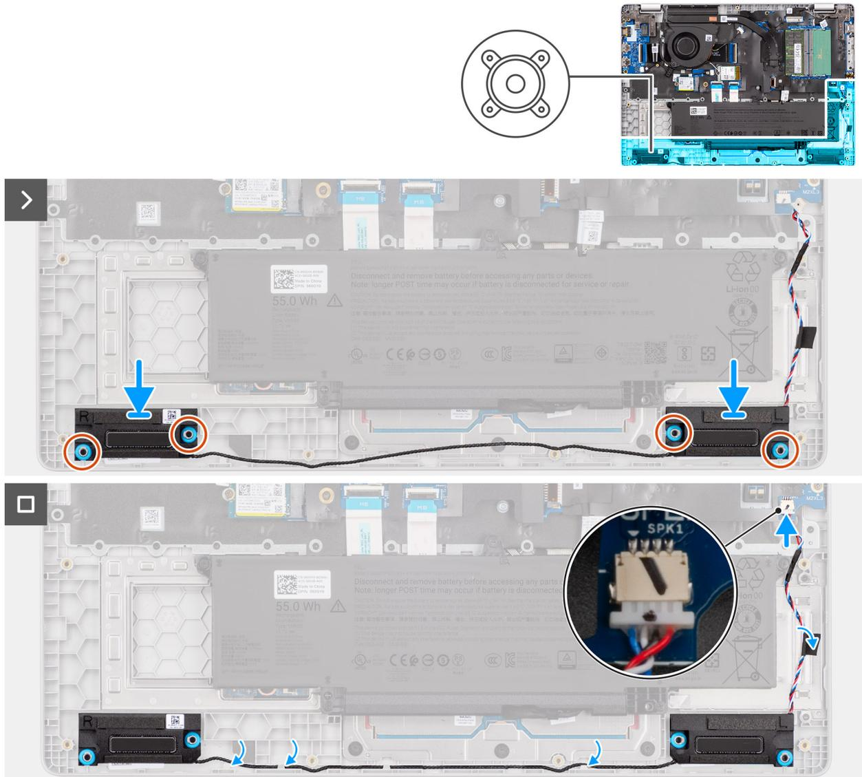
**Ilustración 31. Instalación de los parlantes**
