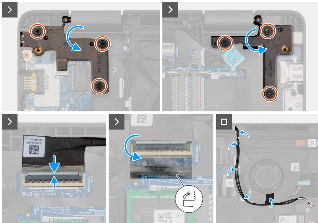
**Ilustración 97. Instalación del ensamblaje de la pantalla**
