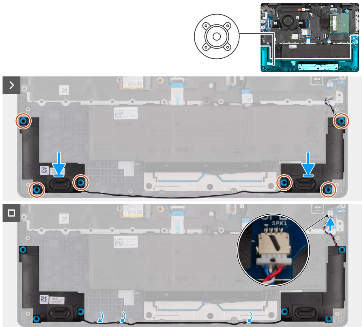
Ilustración 28. Instalación de los parlantes
