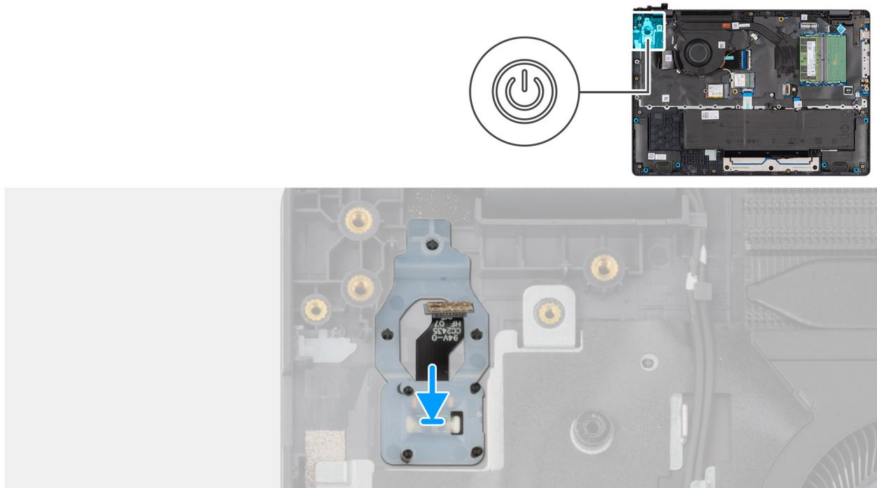
**Ilustración 56. Instalación del botón de encendido con un lector de huellas digitales**
