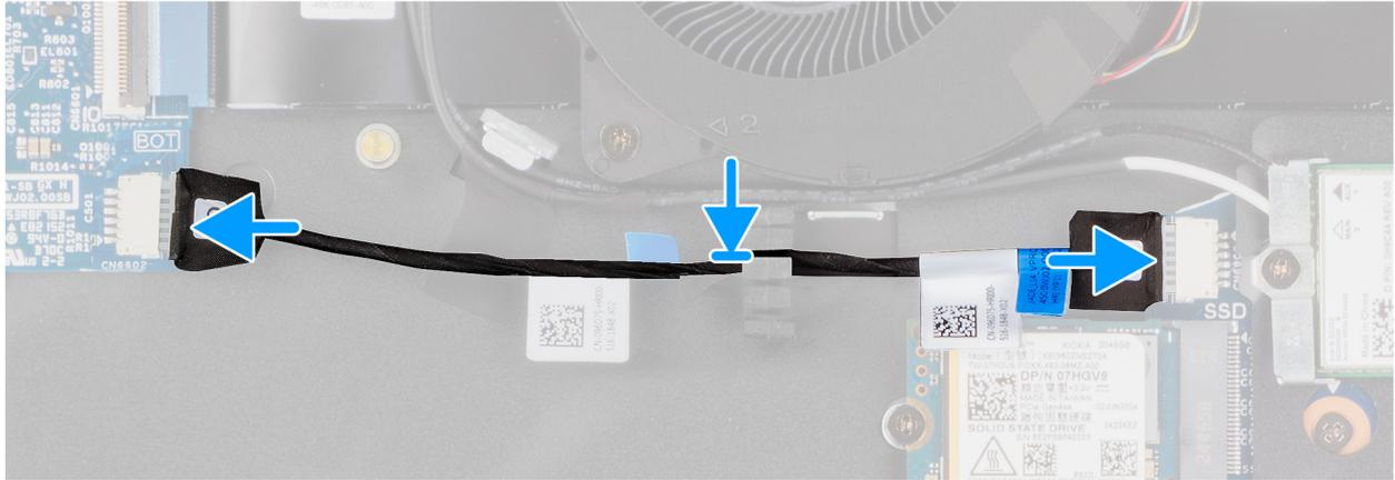
**Ilustración 46. Instalación del cable de vPro**
