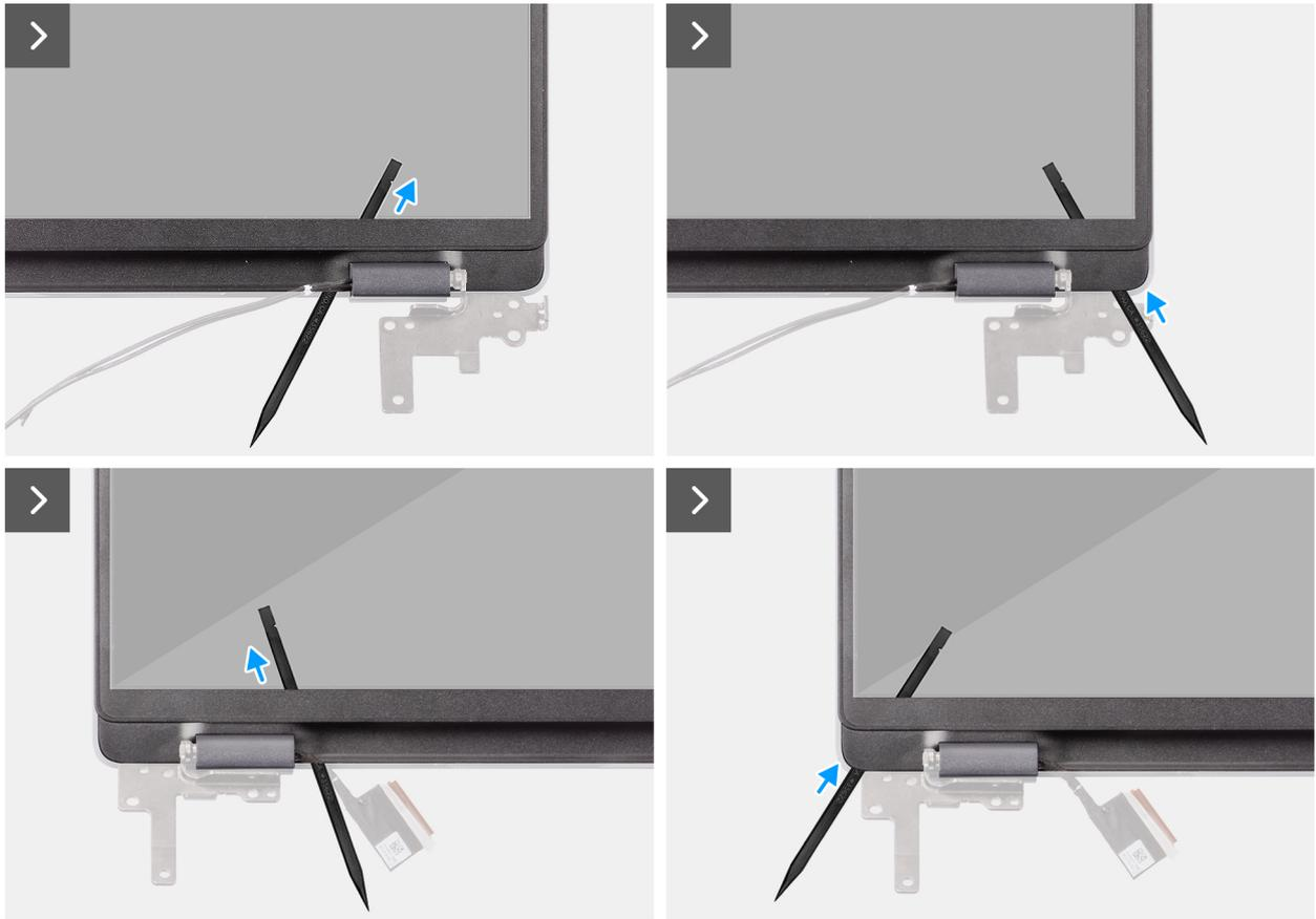
**Ilustración 100. Extracción del embellecedor de la pantalla**
