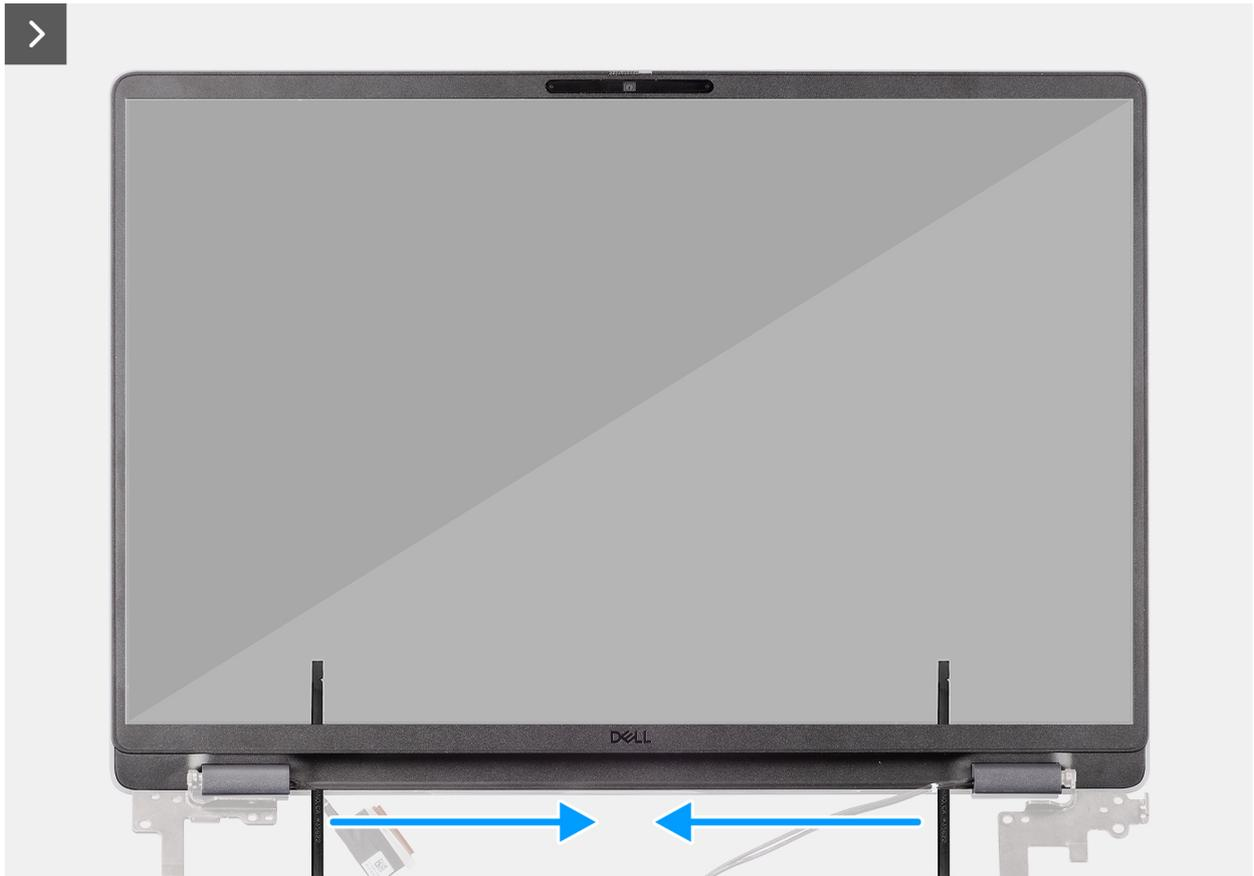
**Ilustración 99. Extracción del embellecedor de la pantalla**
