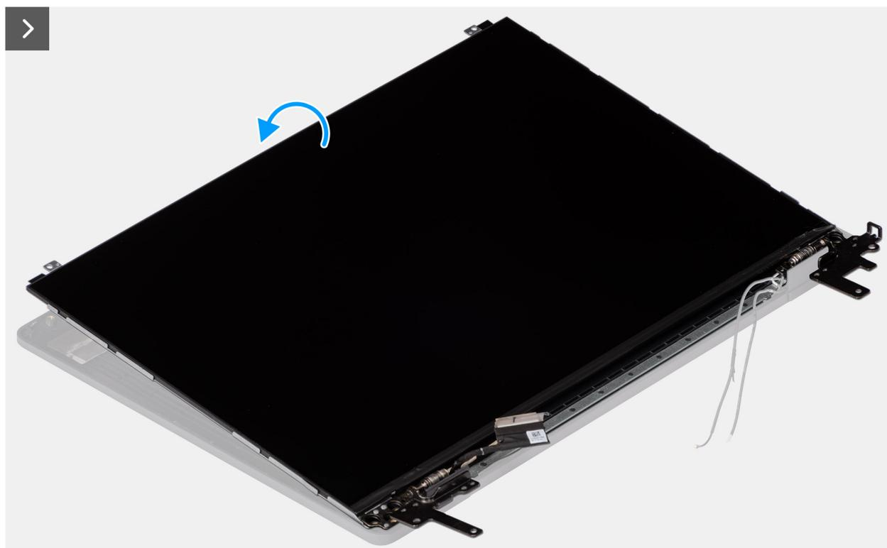
**Ilustración 111. Instalación del ensamblaje del panel de pantalla**
