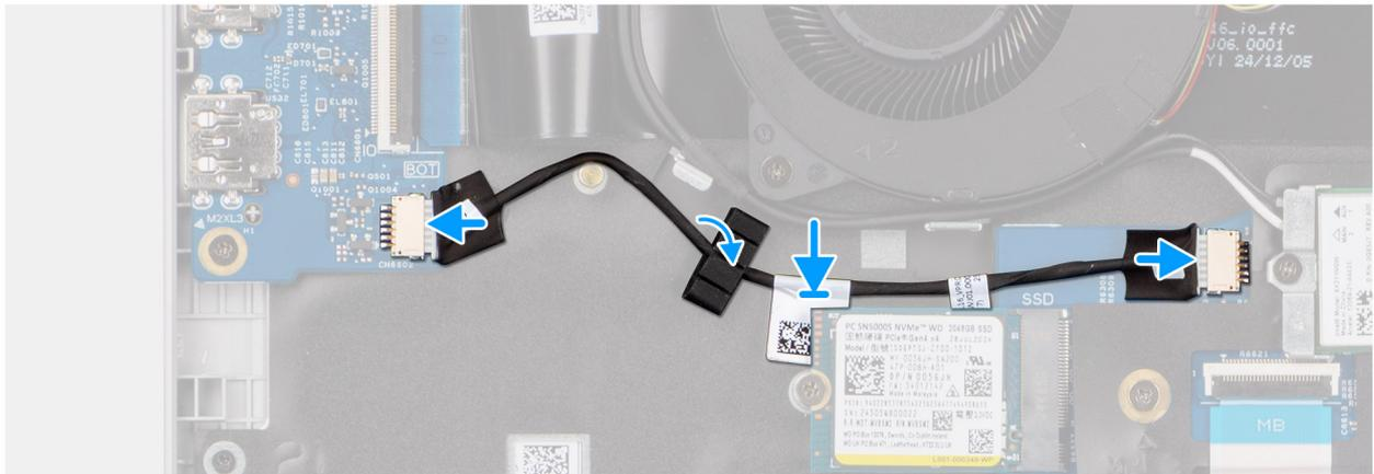
**Ilustración 48. Instalación del cable de vPro**
