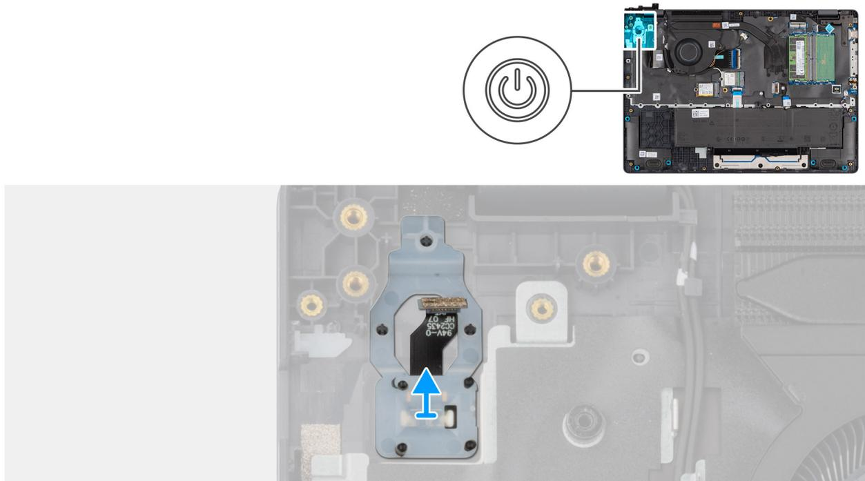
**Ilustración 55. Extracción del botón de encendido con lector de huellas digitales**
