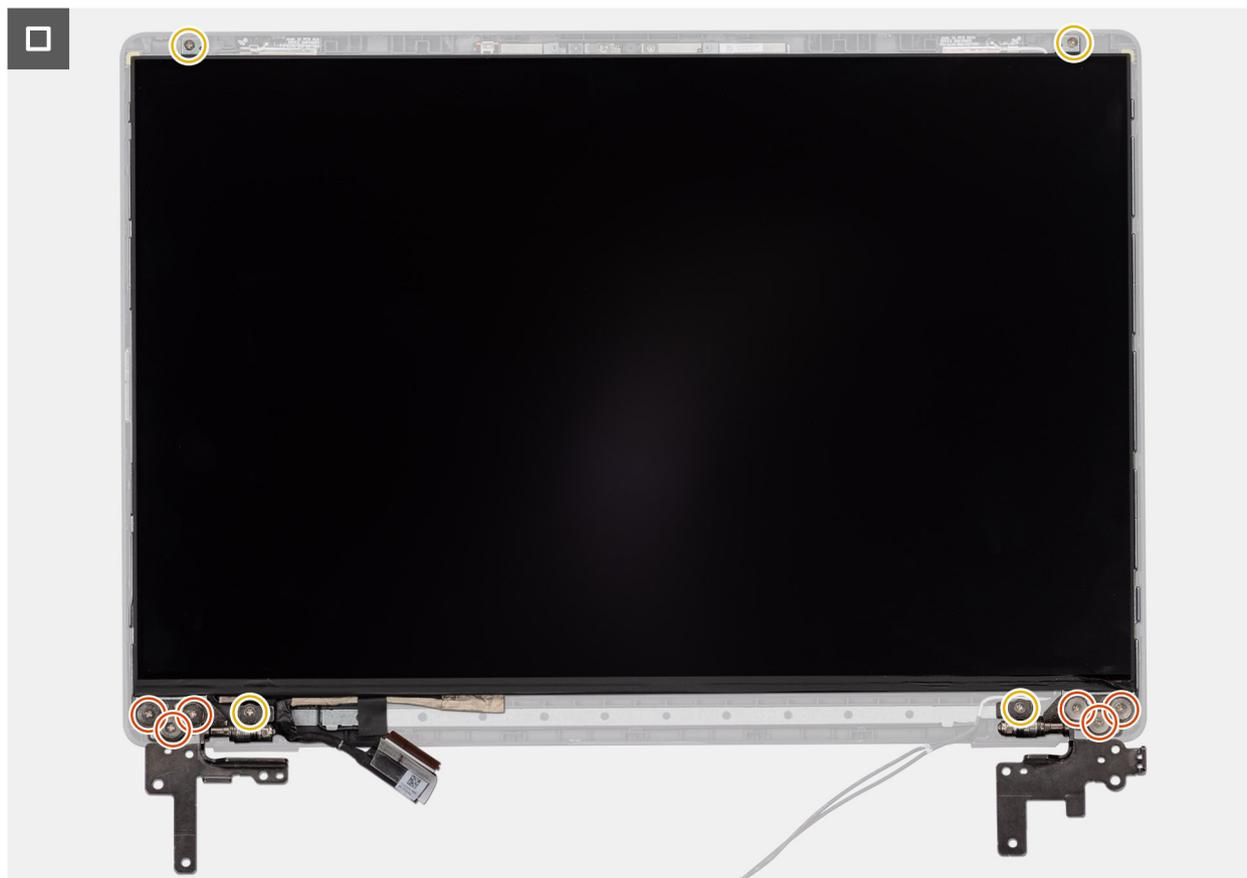
**Ilustración 112. Instalación del ensamblaje del panel de pantalla**
