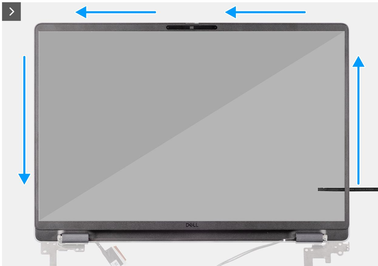
**Ilustración 101. Extracción del embellecedor de la pantalla**
