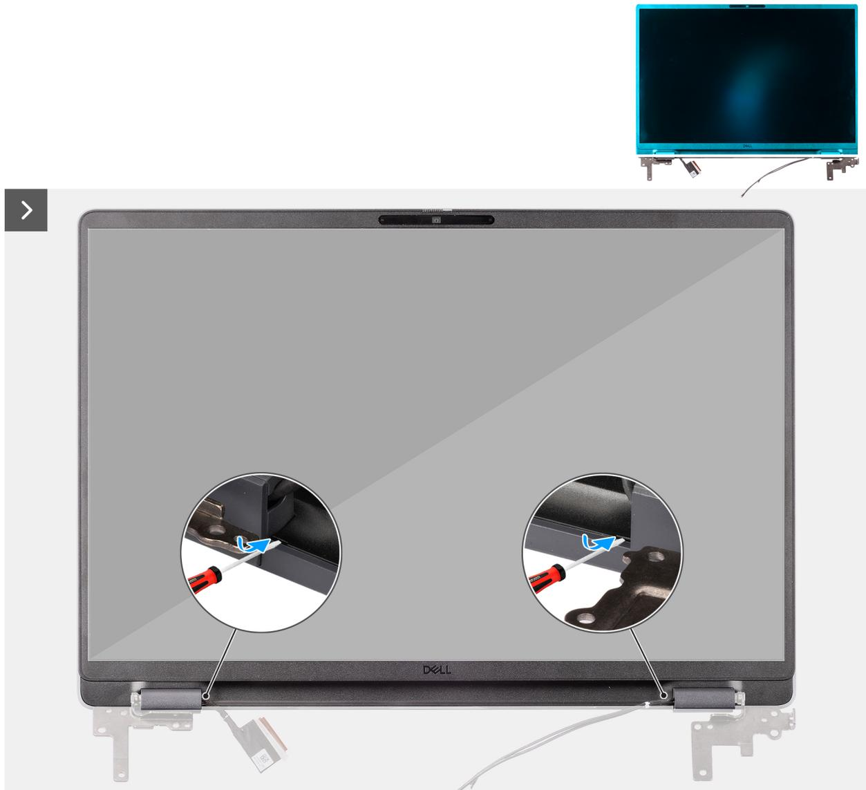
**Ilustración 98. Extracción del embellecedor de la pantalla**
