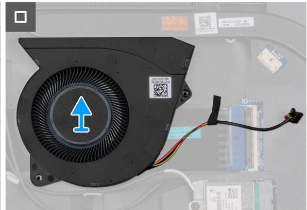
**Ilustración 33. Extracción del ventilador**
