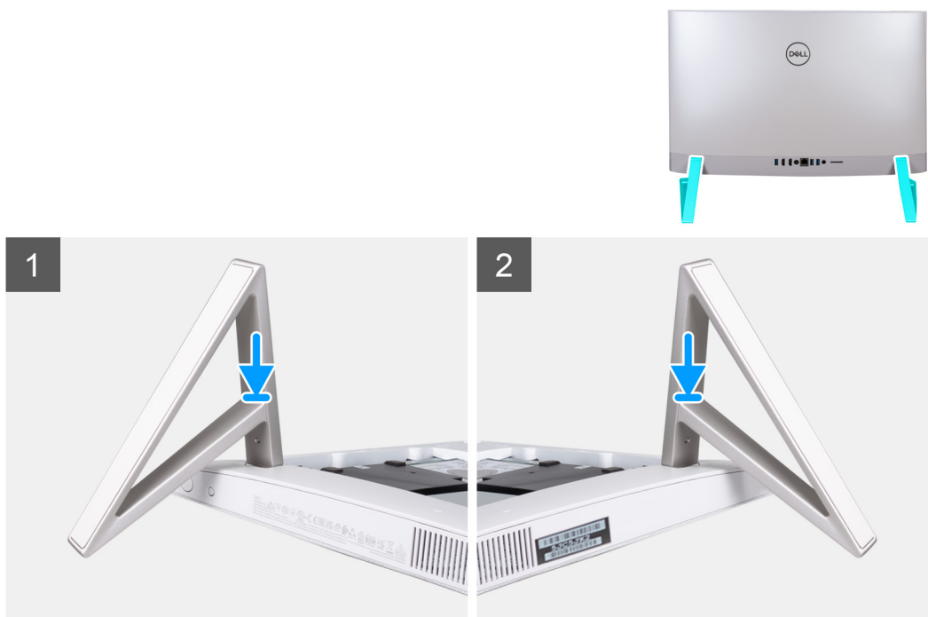
Ilustración 19. Instalación de la base
