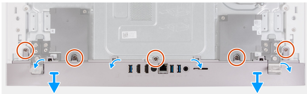
Ilustración 23. Extracción de la cubierta de I/O
