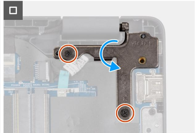
**Ilustración 42. Instalación del puerto del adaptador de alimentación**
