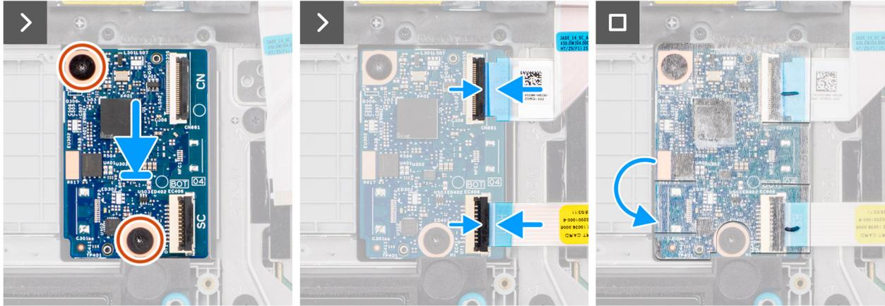
**Ilustración 38. Instalación de la placa USH**
