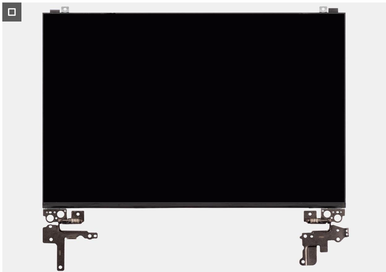
**Ilustración 114. Extracción del ensamblaje del panel de pantalla**
