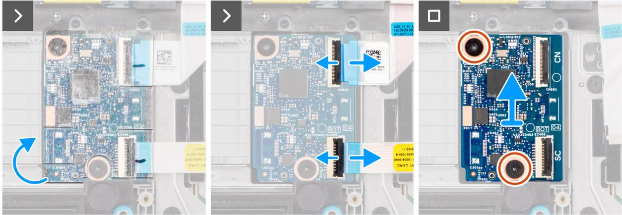
**Ilustración 37. Extracción de la placa USH**
