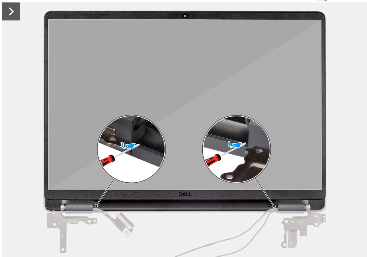
**Ilustración 104. Extracción del embellecedor de la pantalla**
