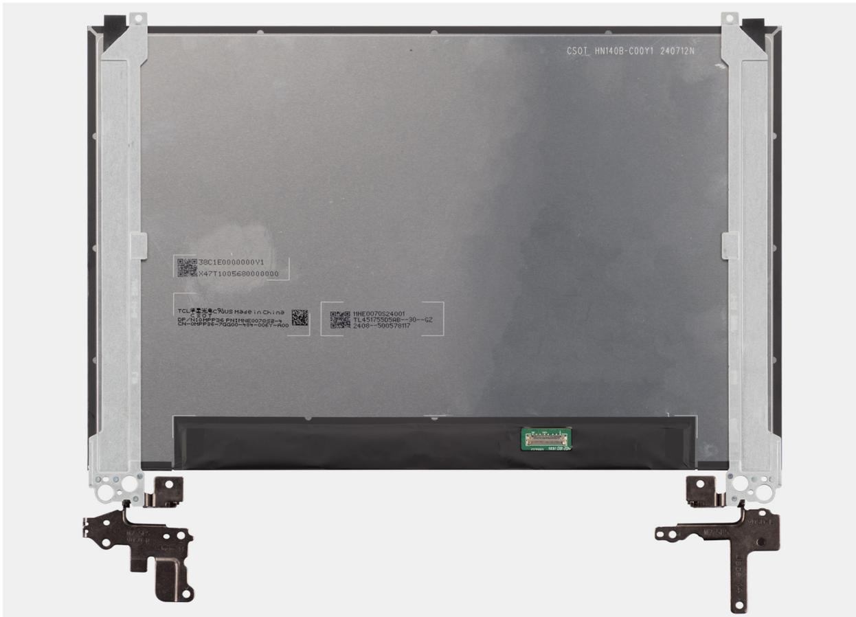
1. Quite los cuatro tornillos (M2.5x2.5) y los cuatro tornillos (M2.5x3.5) que fijan las bisagras izquierda y derecha a la cubierta posterior de la pantalla.
