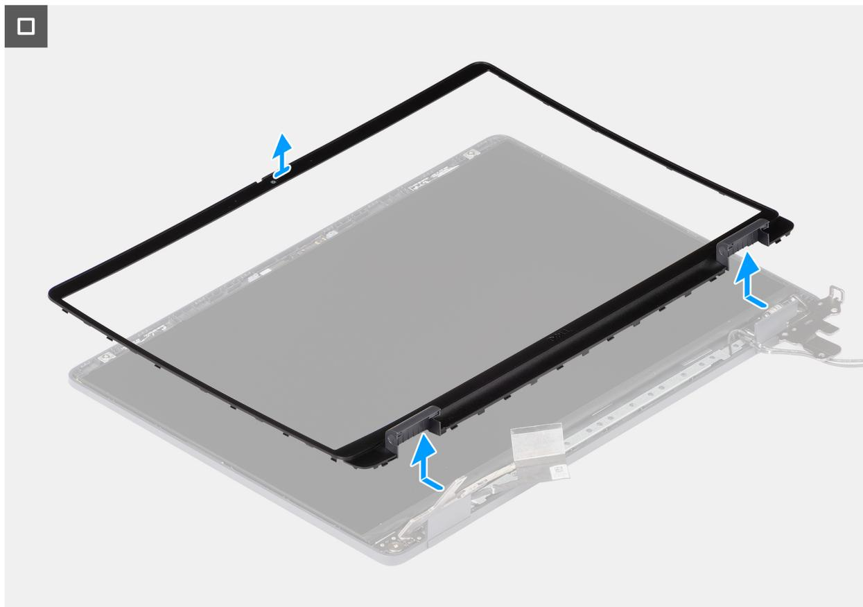
**Ilustración 108. Extracción del embellecedor de la pantalla**
