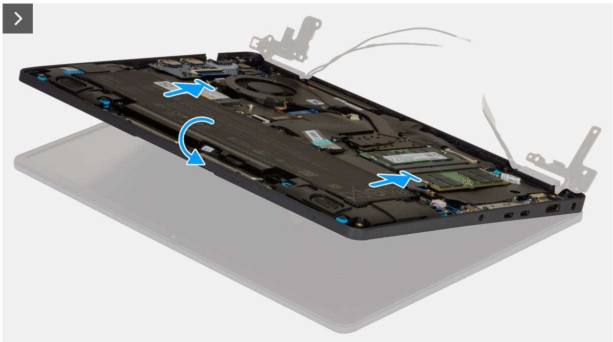
Ilustración 102. Instalación del ensamblaje de la pantalla
