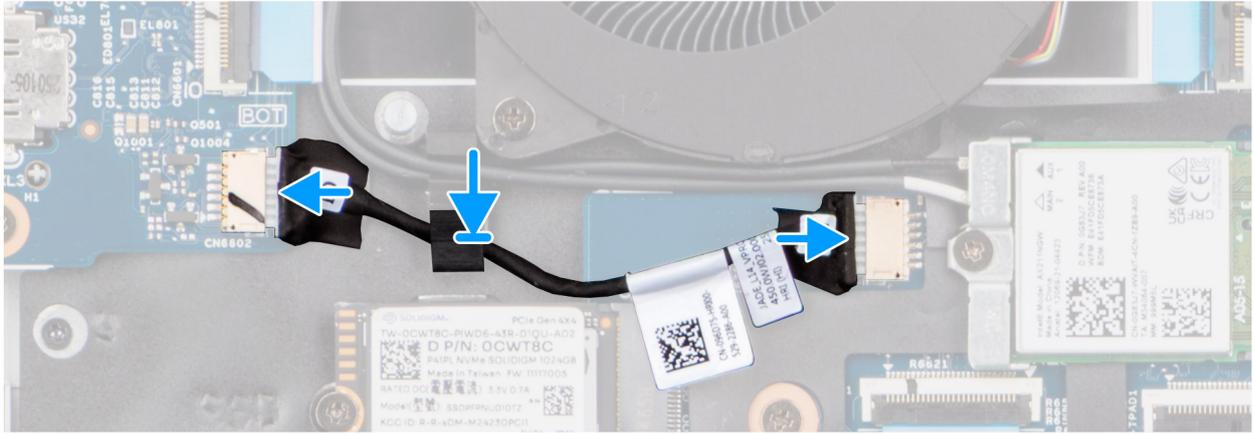
**Ilustración 48. Instalación del cable de vPro**
