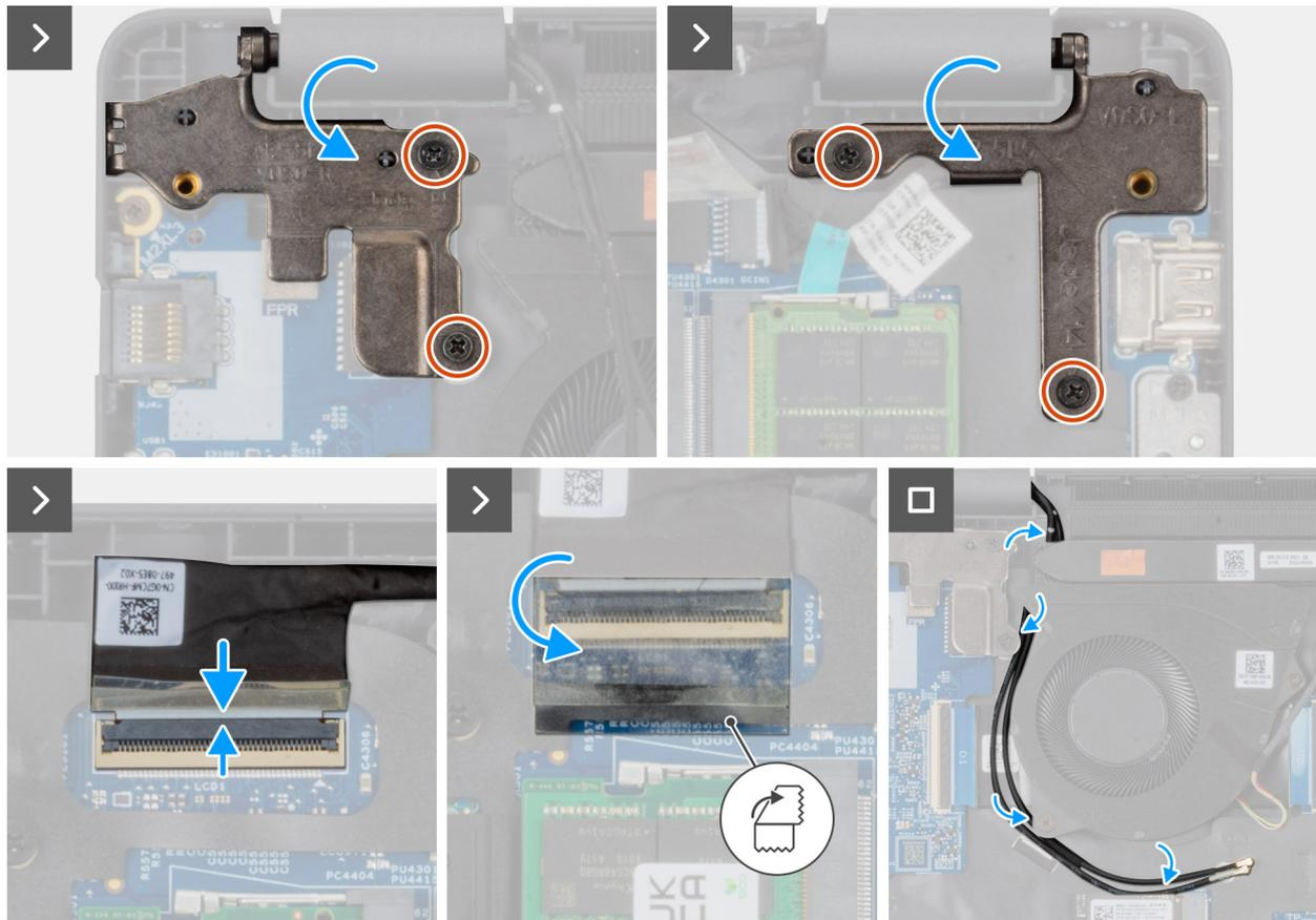
**Ilustración 103. Instalación del ensamblaje de la pantalla**
