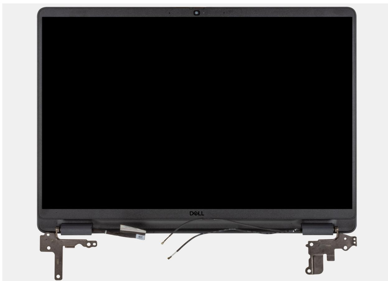
Ilustración 101. Extracción del ensamblaje de la pantalla
