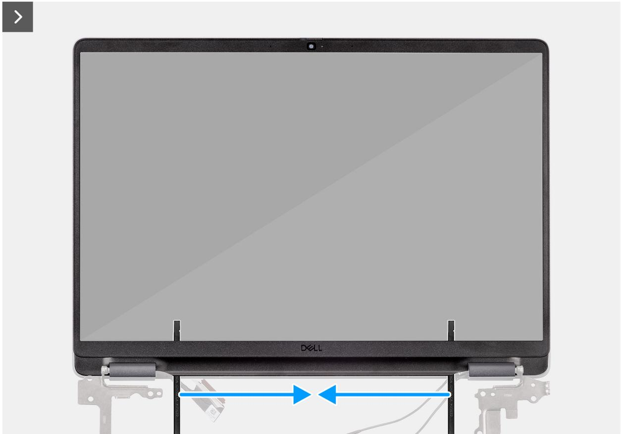
**Ilustración 105. Extracción del embellecedor de la pantalla**
