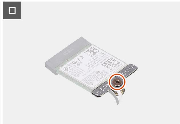
Ilustración 26. Instalación de la tarjeta inalámbrica
