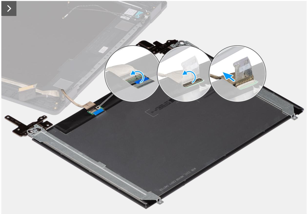
**Ilustración 113. Extracción del ensamblaje del panel de pantalla**
