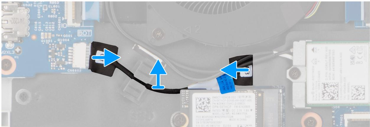
**Ilustración 45. Extracción del cable de vPro**
