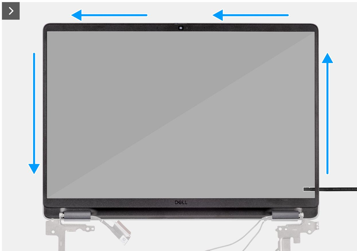
**Ilustración 107. Extracción del embellecedor de la pantalla**
