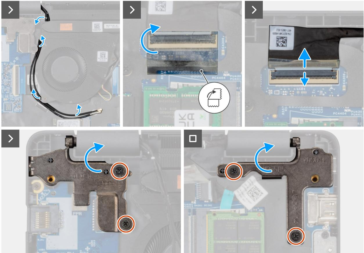
Ilustración 99. Extracción del ensamblaje de la pantalla
