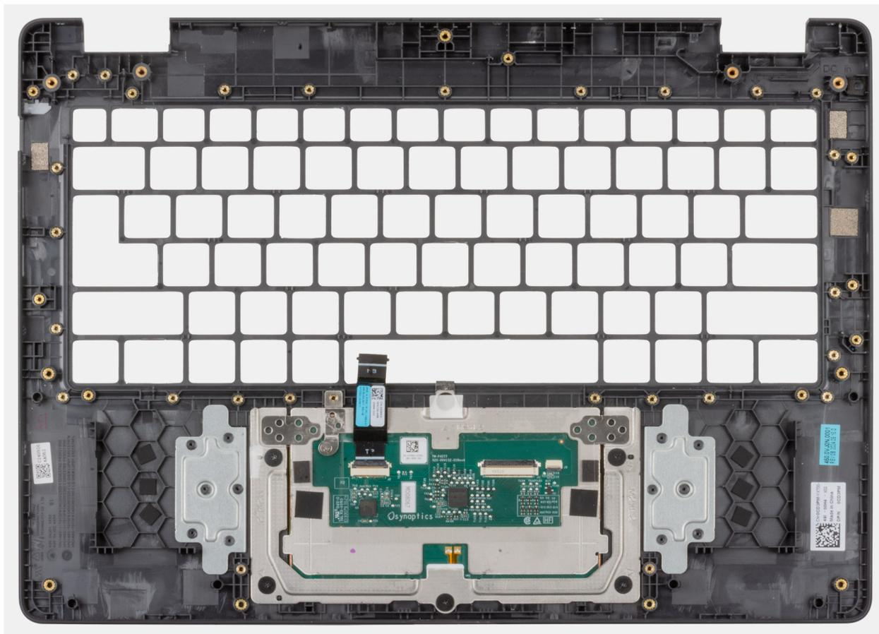
**Ilustración 95. Extracción del ensamblaje y el reposamanos**
