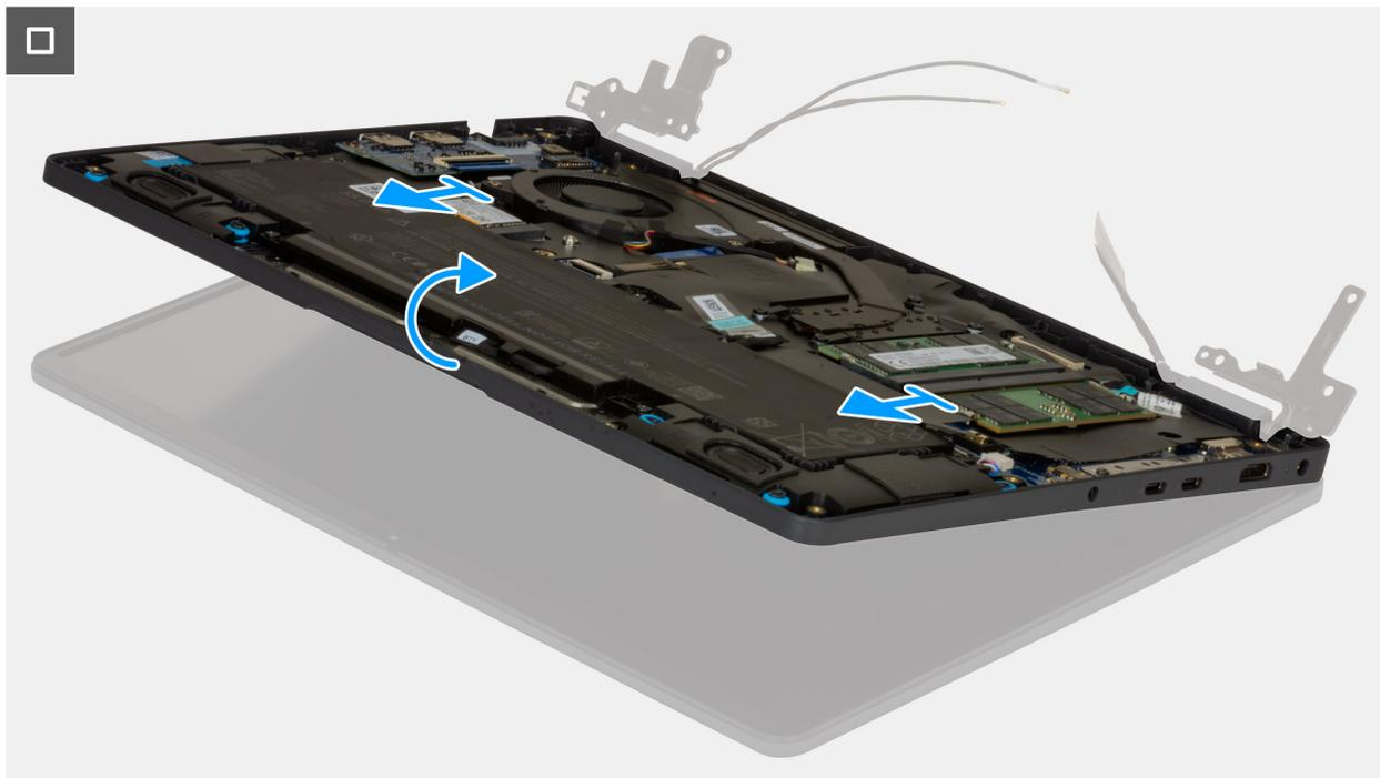
Ilustración 100. Extracción del ensamblaje de la pantalla
