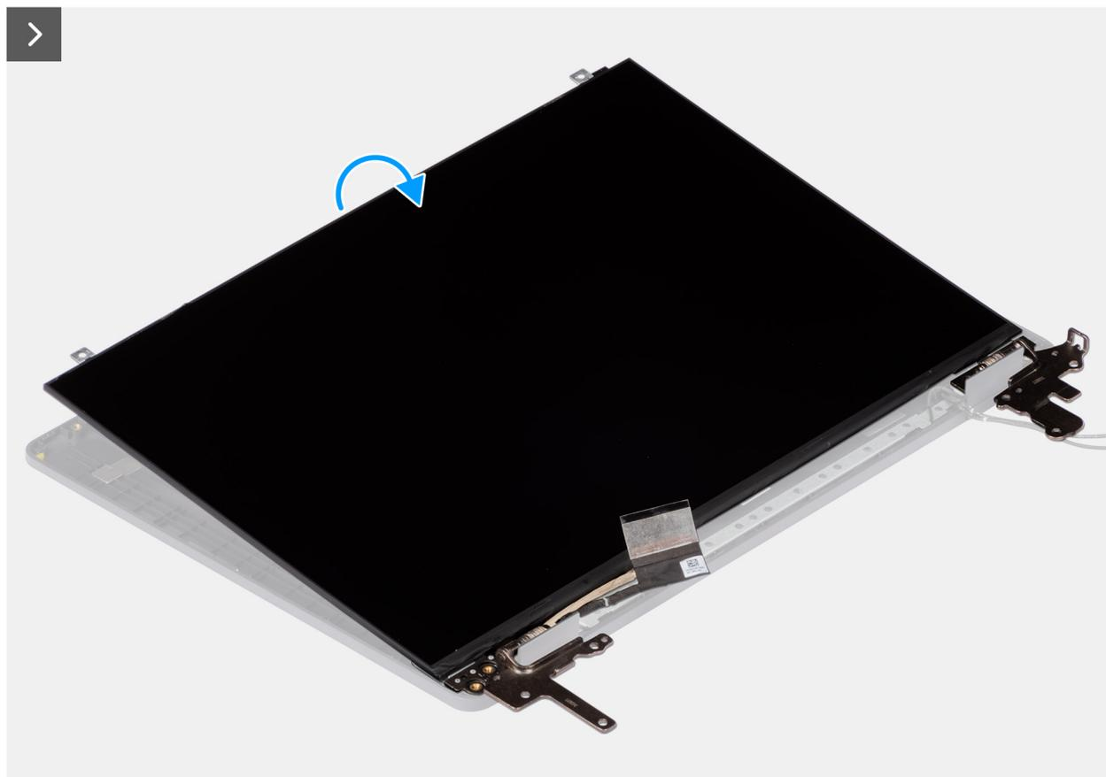
**Ilustración 112. Extracción del ensamblaje del panel de pantalla**
