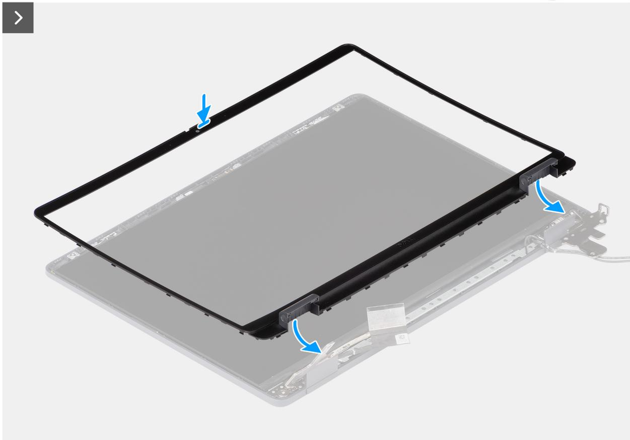
Ilustración 109. Instalación del bisel de la pantalla
