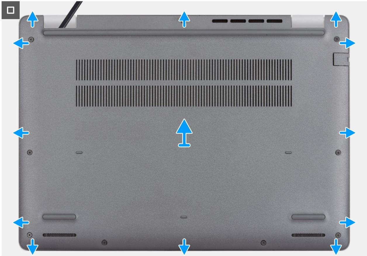
**Ilustración 12. Extracción de la cubierta de la base**
