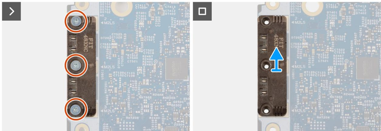
**Ilustración 77. Extracción del módulo USB Type-C**
