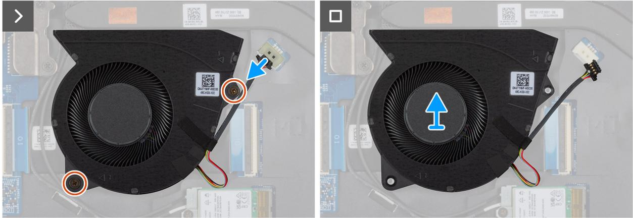
**Ilustración 33. Extracción del ventilador**
