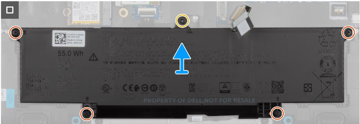
**Ilustración 17. Extracción de la batería**
