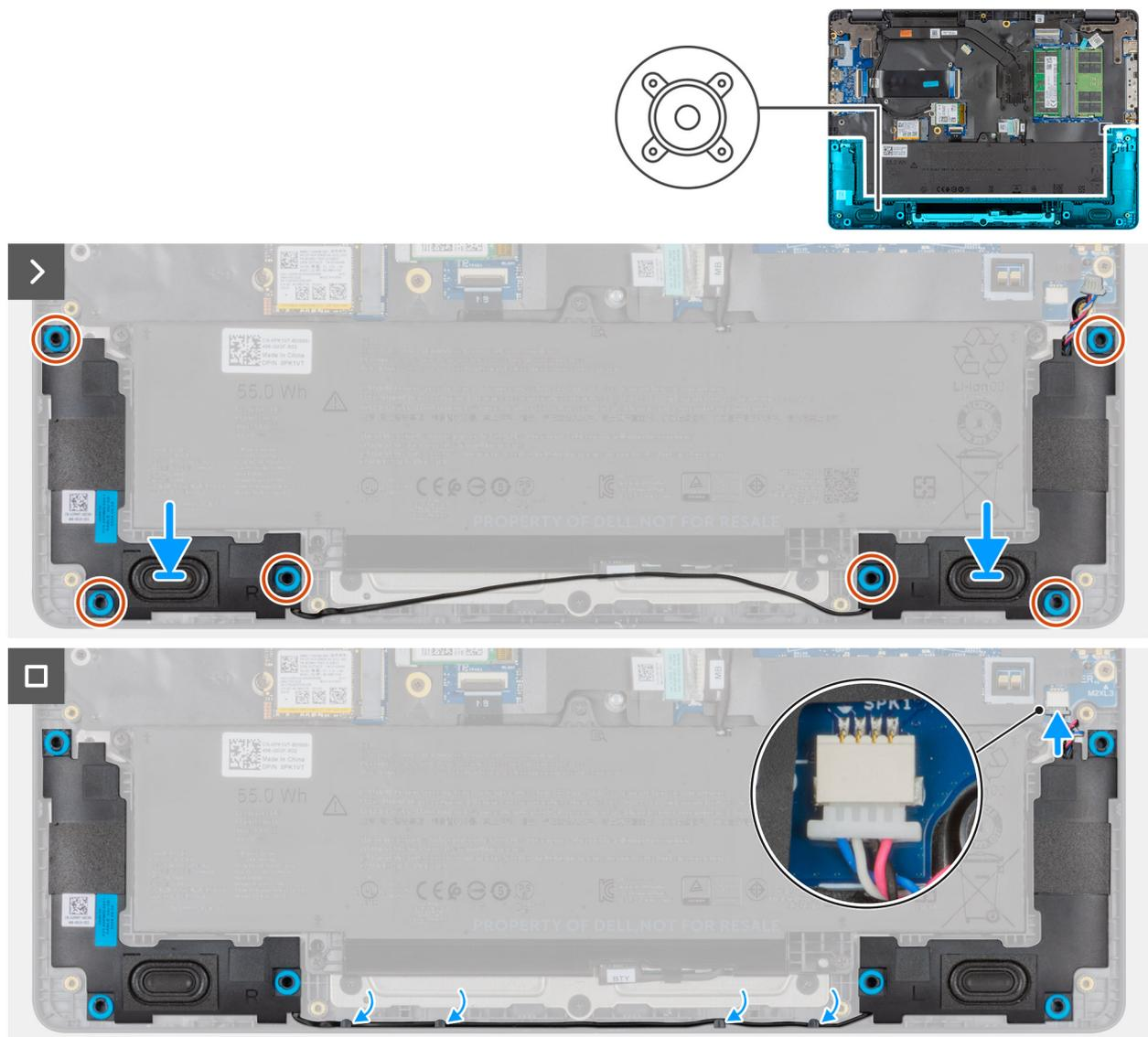
Ilustración 28. Instalación de los parlantes
