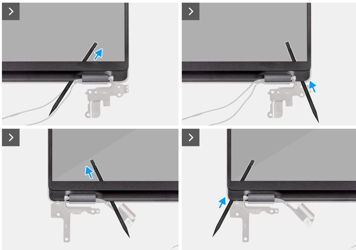
Ilustración 106. Extracción del embellecedor de la pantalla
