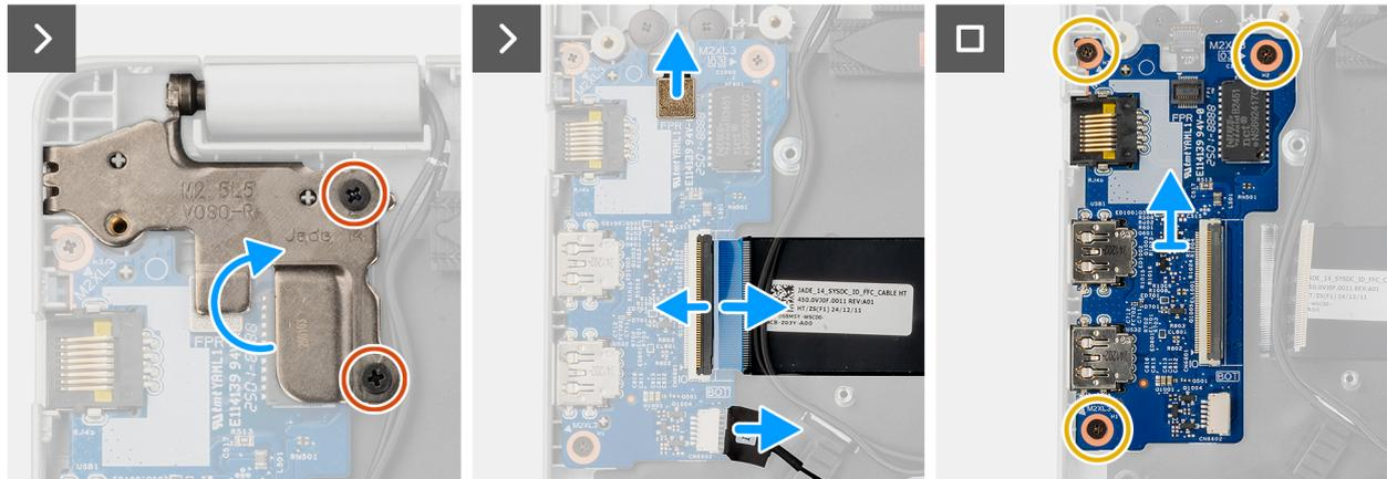
**Ilustración 51. Extracción de la placa de I/O**
