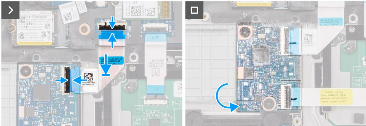
**Ilustración 36. Instalación del FPC de la placa USH**
