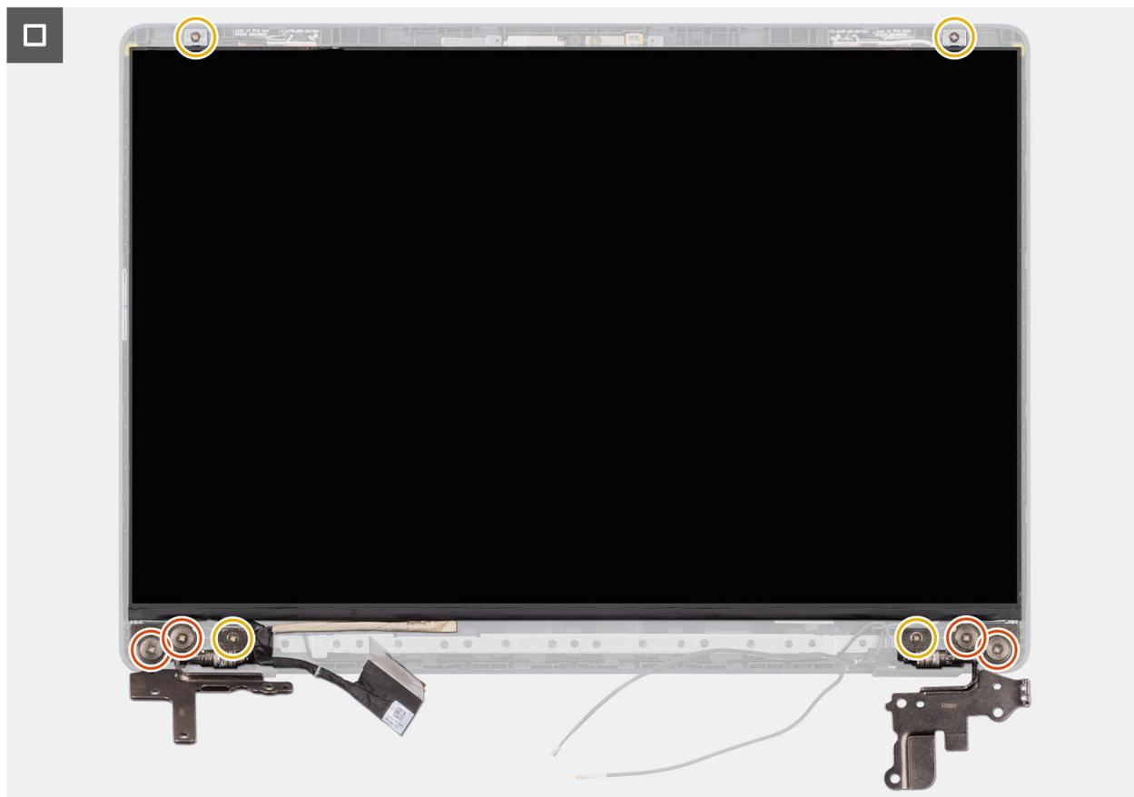
**Ilustración 118. Instalación del ensamblaje del panel de pantalla**
