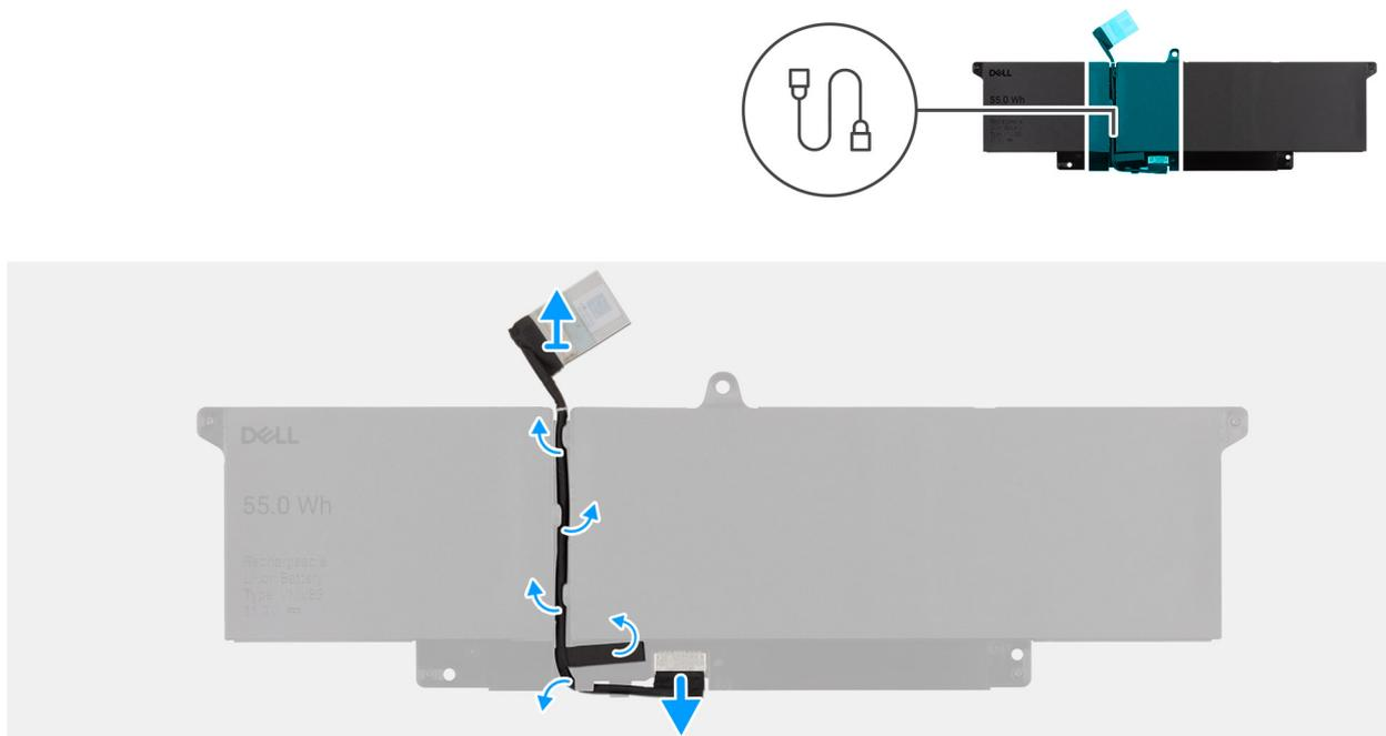
**Ilustración 19. Extracción del cable de la batería**
