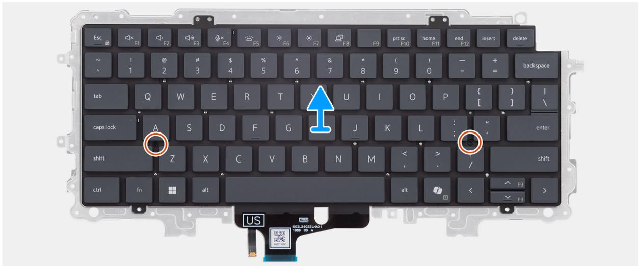
Ilustración 91. Extracción de la placa de soporte del teclado
