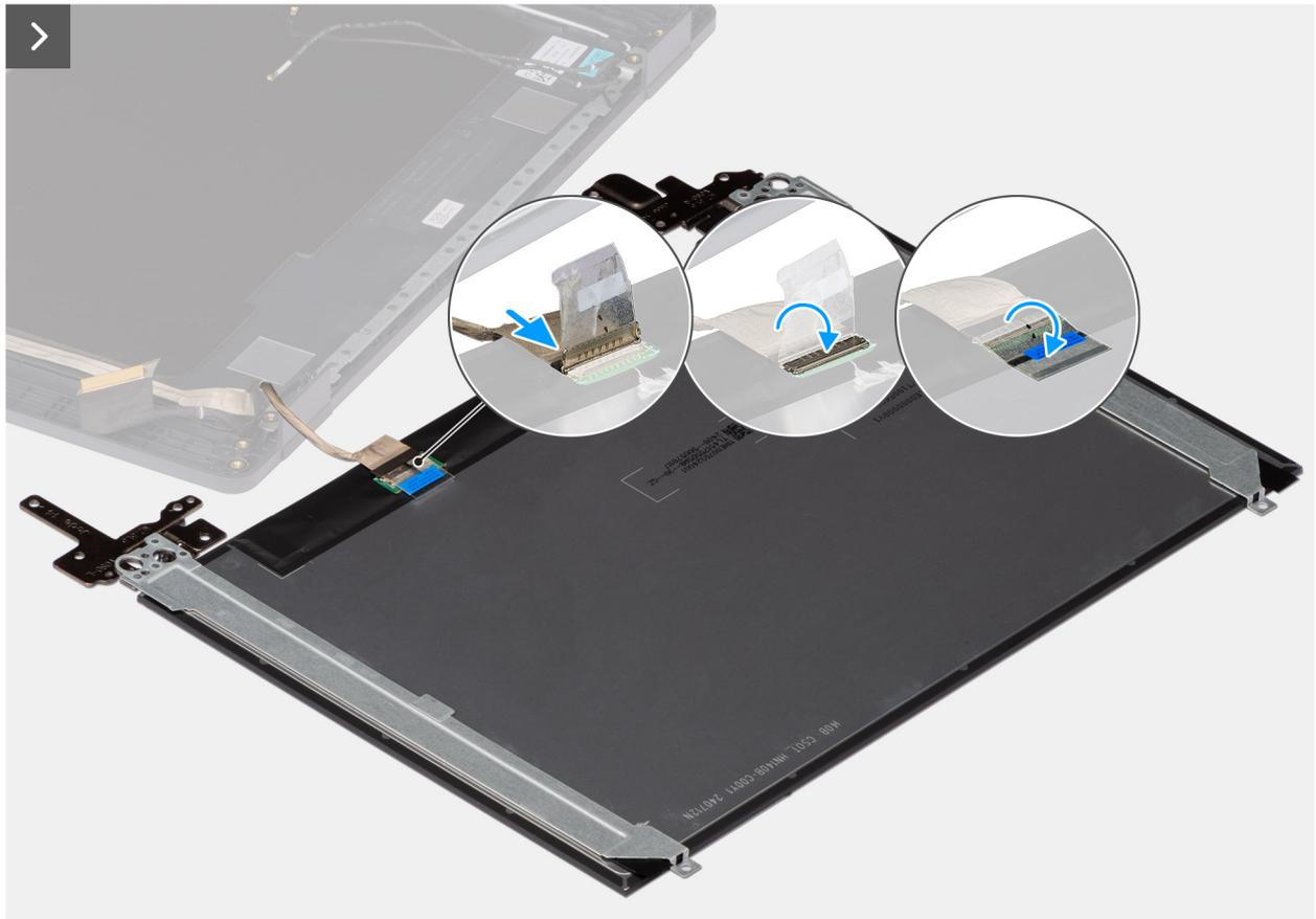
**Ilustración 116. Instalación del ensamblaje del panel de pantalla**
