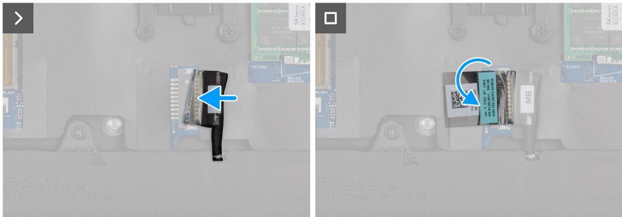
Ilustración 14. Conexión del cable de la batería
