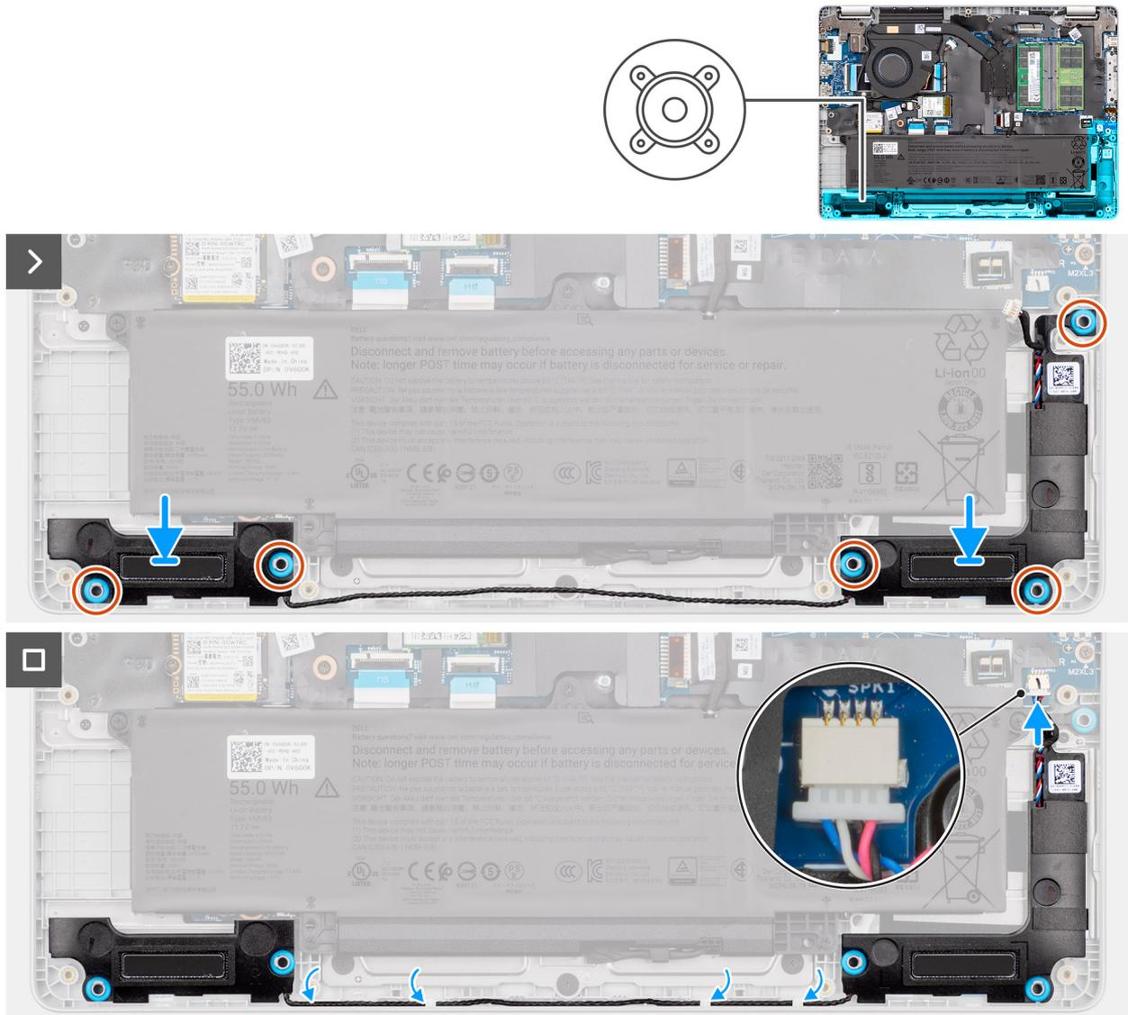
**Ilustración 31. Instalación de los parlantes**
