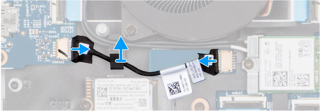
**Ilustración 47. Extracción del cable de vPro**
