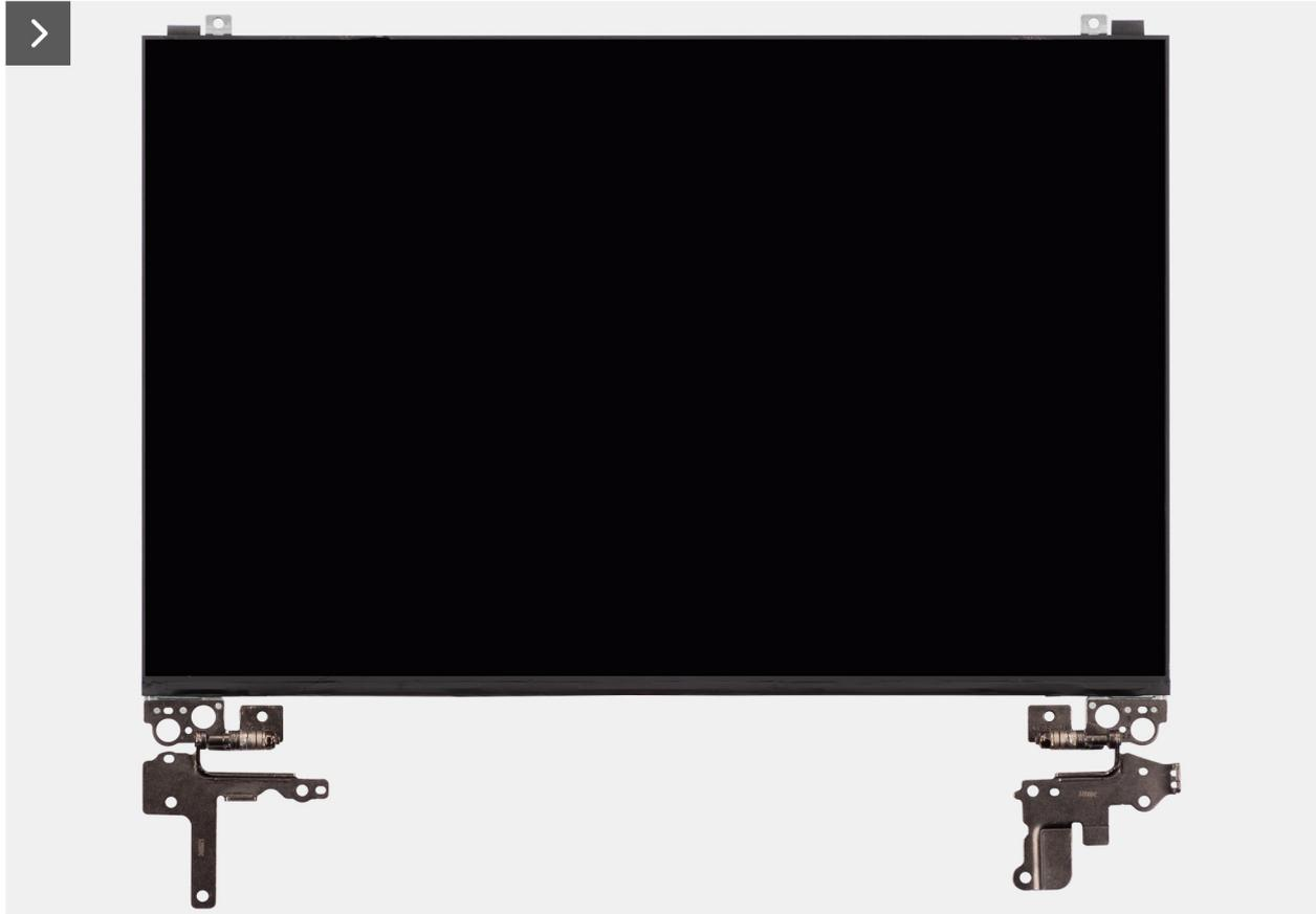
**Ilustración 115. Instalación del ensamblaje del panel de pantalla**
