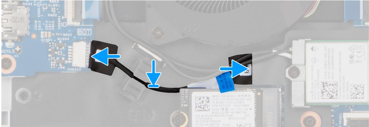
**Ilustración 46. Instalación del cable de vPro**
