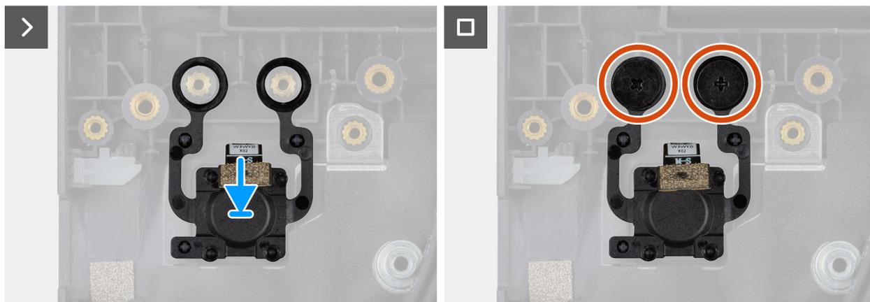
**Ilustración 56. Instalación del botón de encendido con un lector de huellas digitales**
