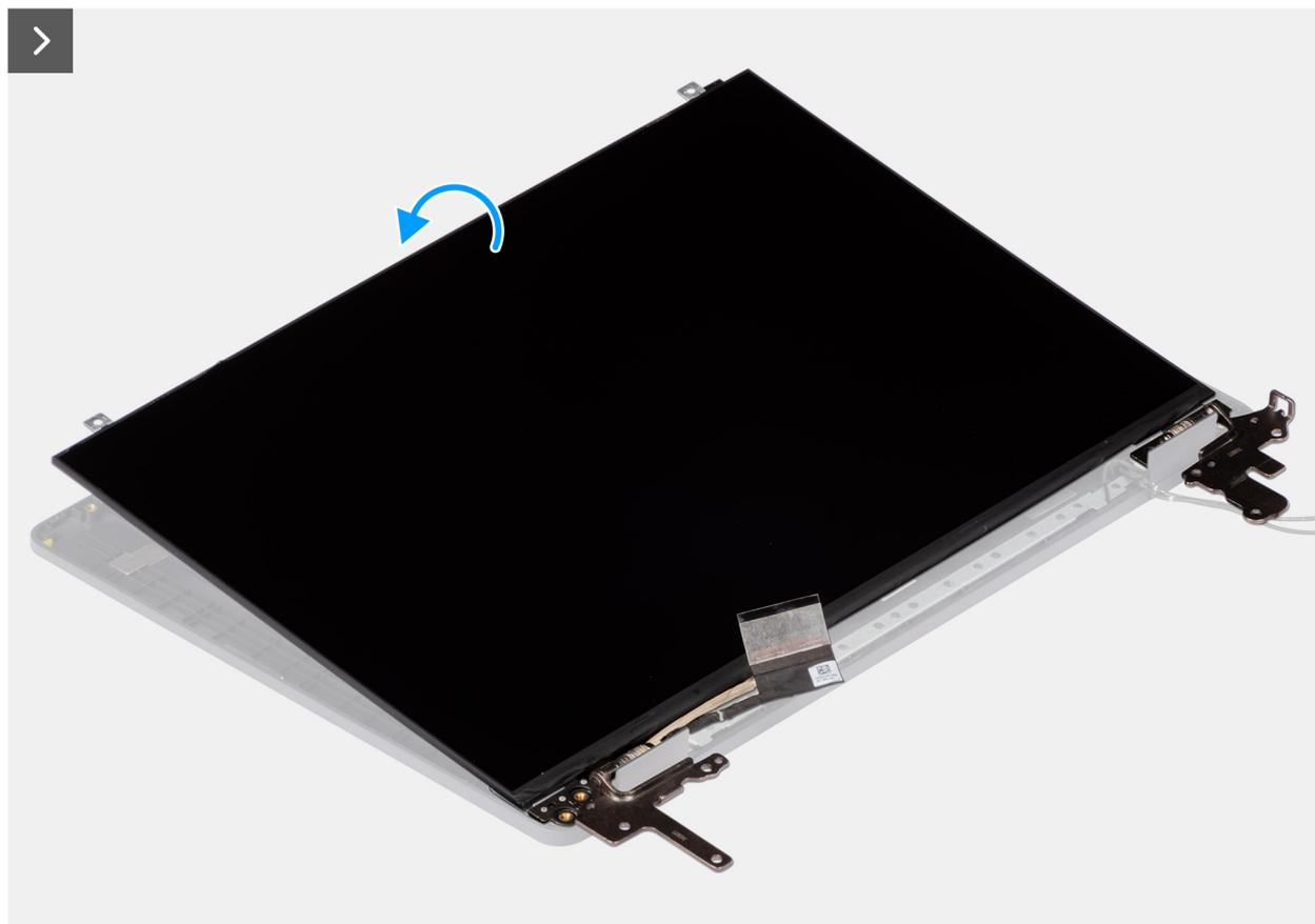
**Ilustración 117. Instalación del ensamblaje del panel de pantalla**
