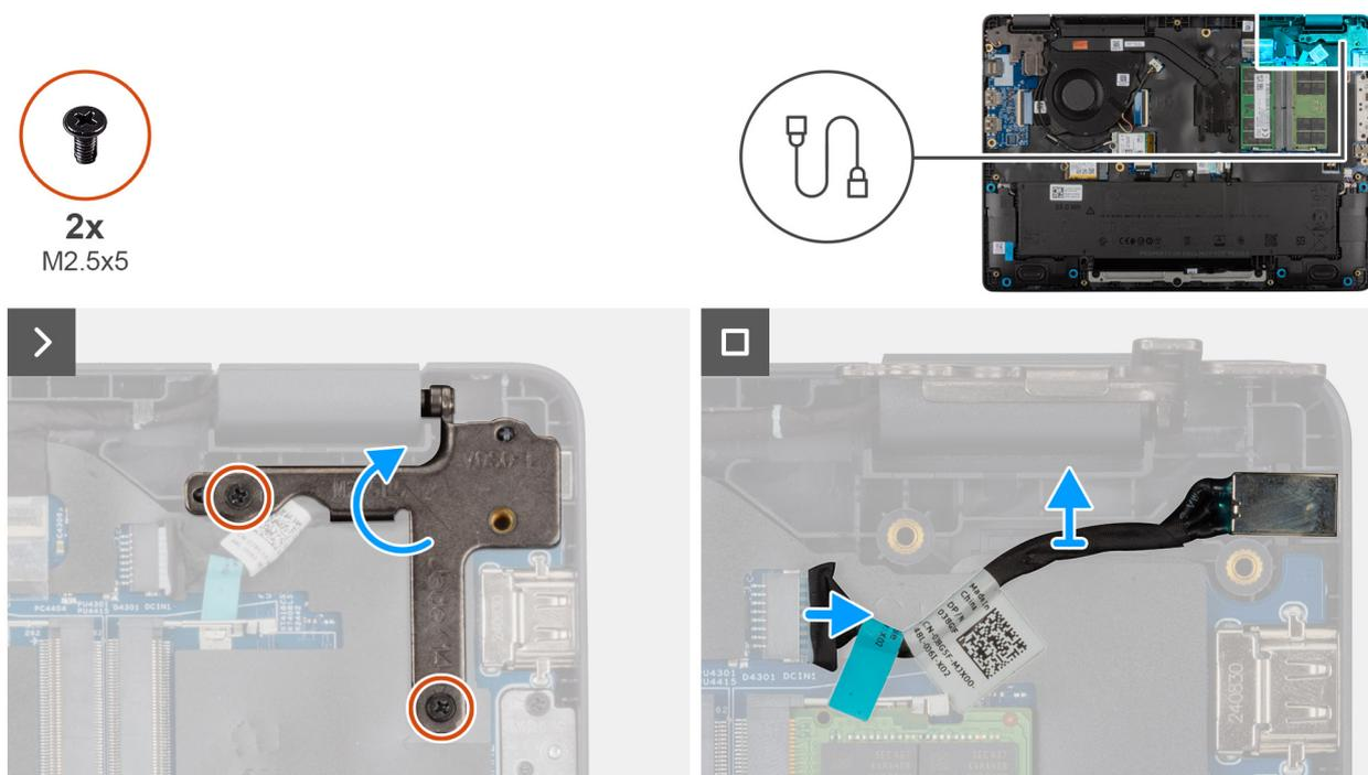
**Ilustración 41. Extracción del puerto del adaptador de alimentación**
