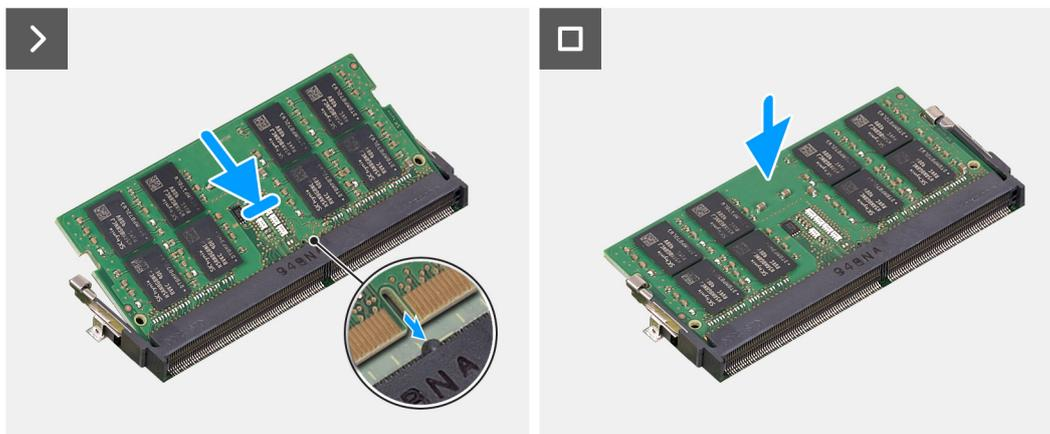
**Ilustración 32. Instalación del módulo de memoria**
