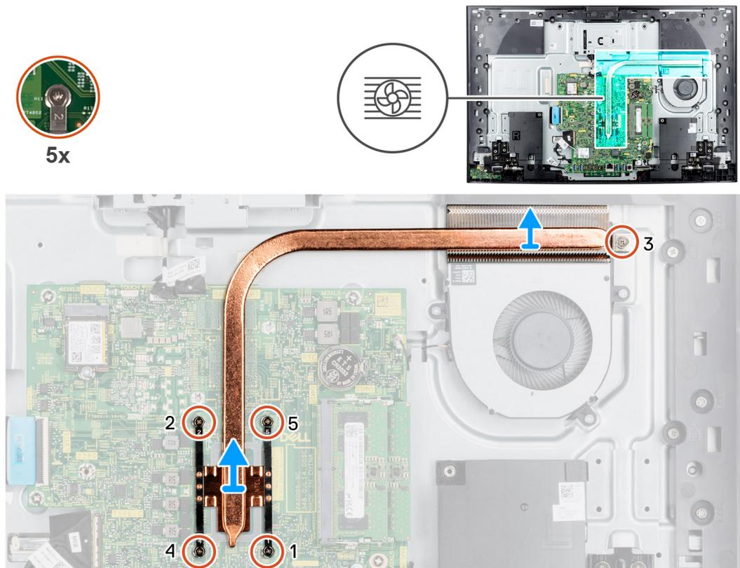
**Ilustración 43. Extracción del disipador de calor: UMA**
