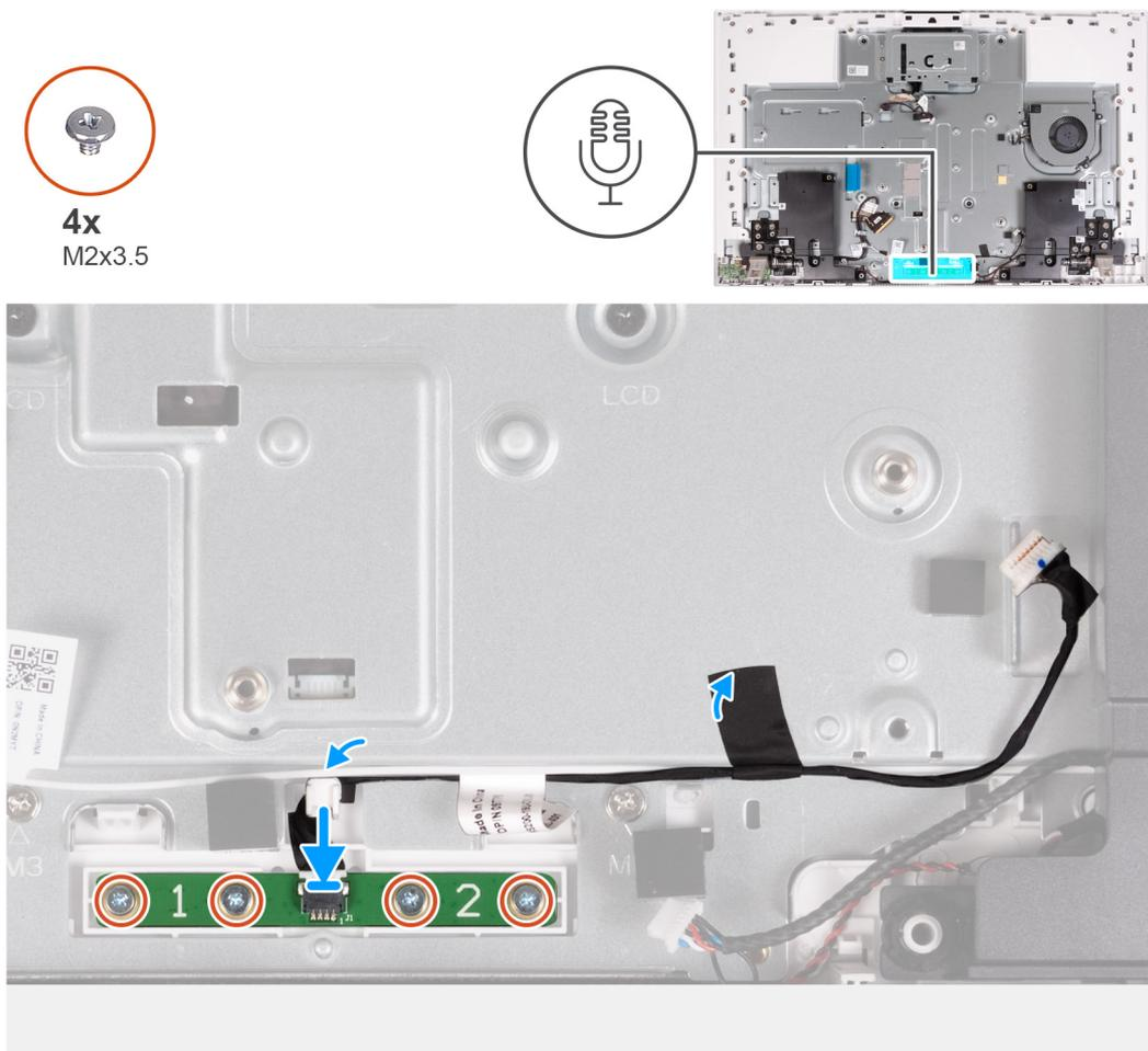
**Ilustración 58. Instalación del módulo del micrófono**
