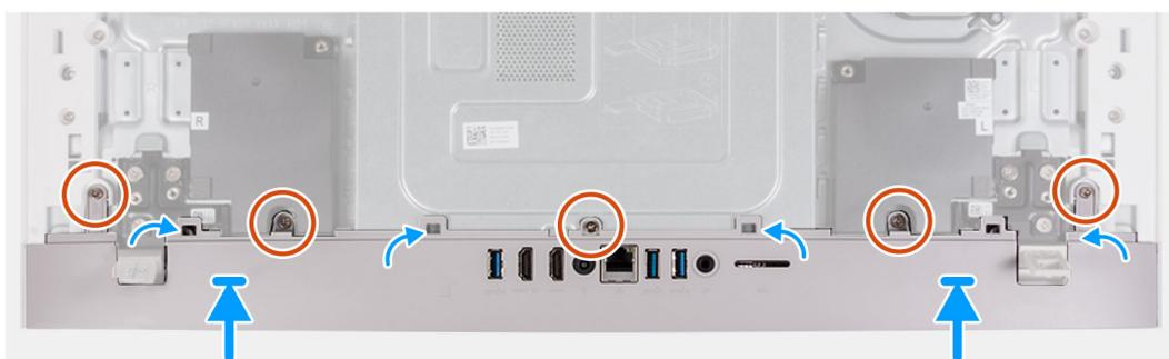
**Ilustración 24. Instalación de la cubierta inferior**
