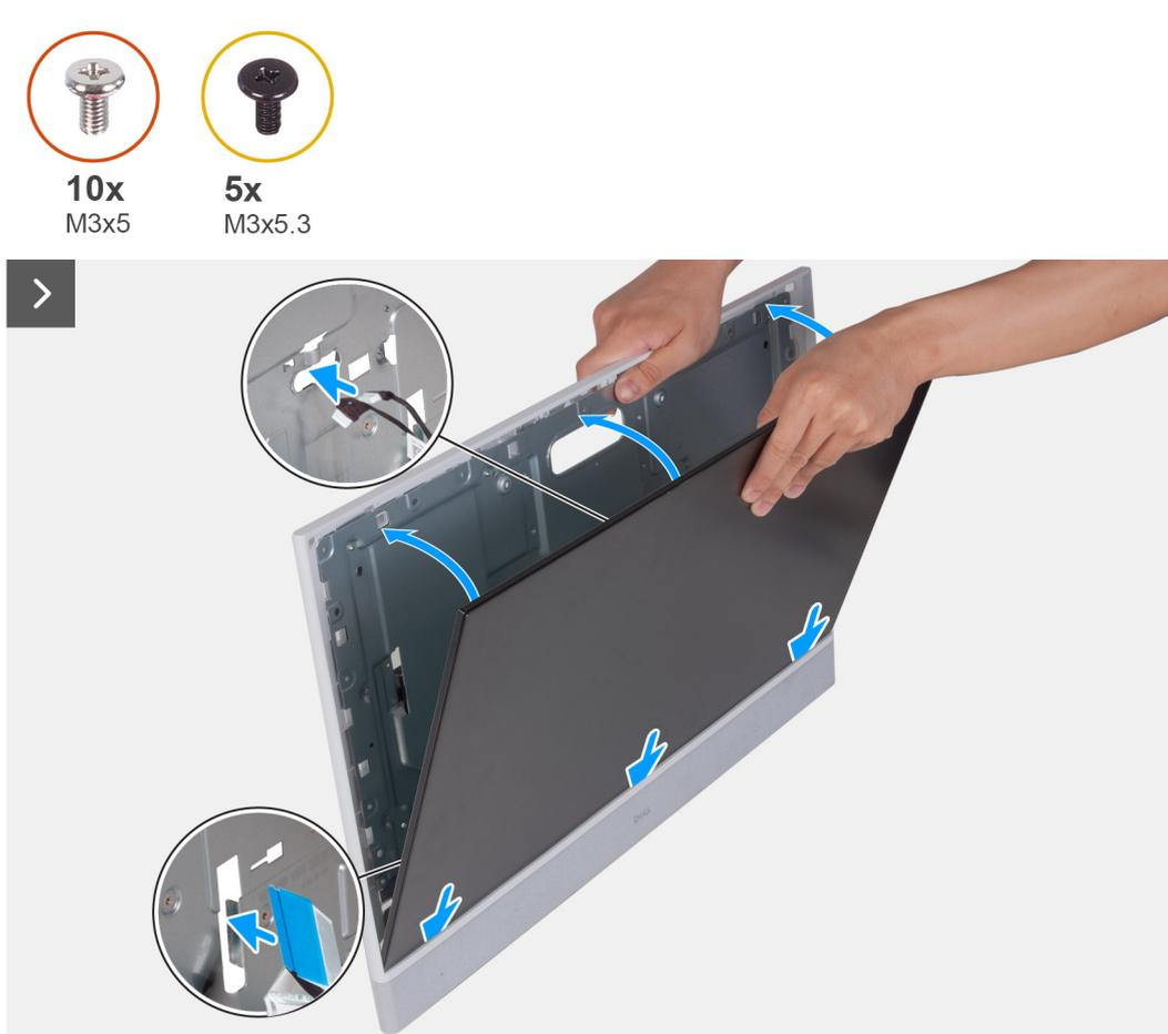
Ilustración 63. Instalación del panel de pantalla
