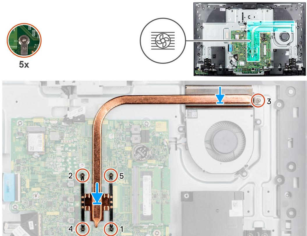
**Ilustración 44. Instalación del disipador de calor: UMA**
