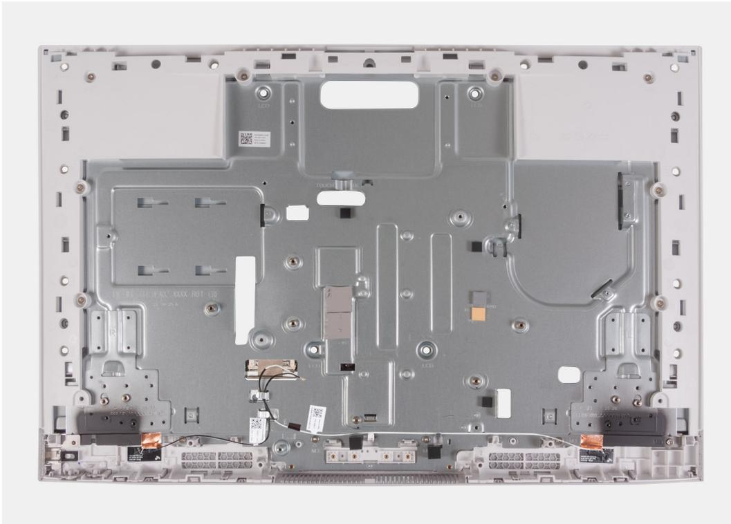
**Ilustración 66. Instalación del ensamblaje de la trama intermedia**
