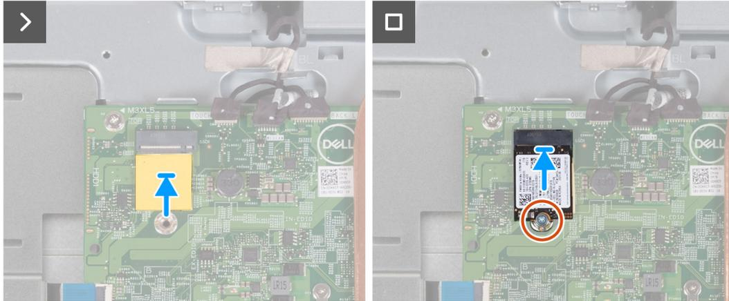
**Ilustración 30. Instalación de la unidad de estado sólido M.2 2230**
