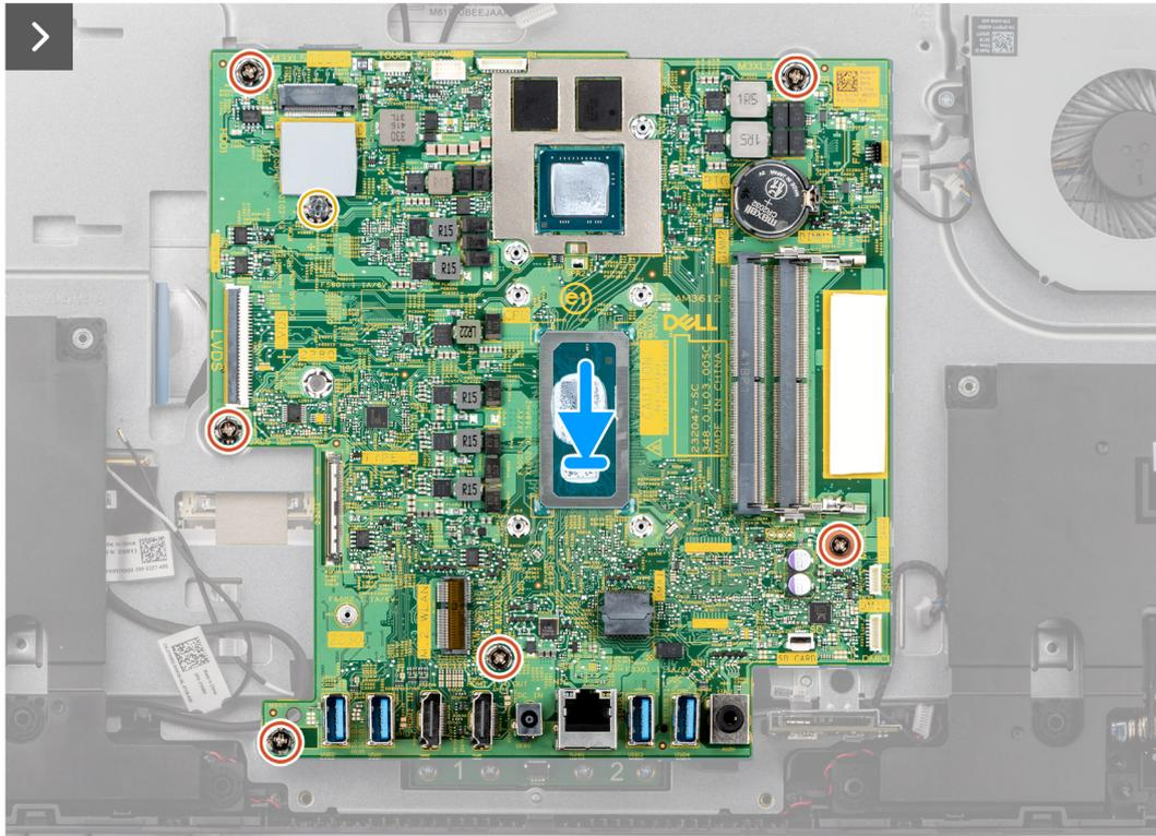
**Ilustración 55. Coloque la tarjeta madre en el chasis**
