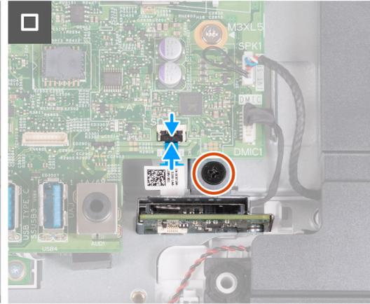
**Ilustración 48. Instalación del lector de tarjetas de medios**
