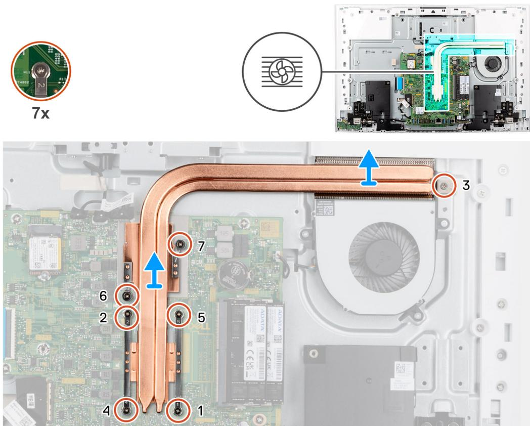
**Ilustración 45. Extracción del disipador de calor: discreto**
