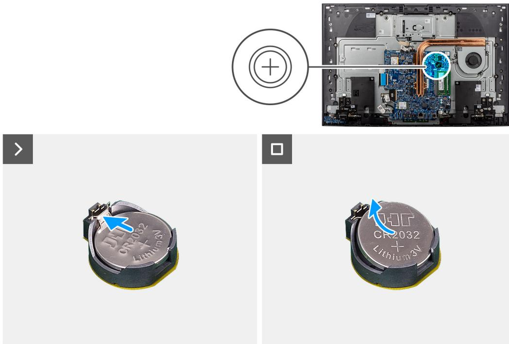
**Ilustración 41. Extracción de la batería de tipo botón**
