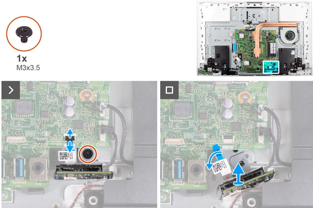
**Ilustración 47. Extracción del lector de tarjetas de medios**
