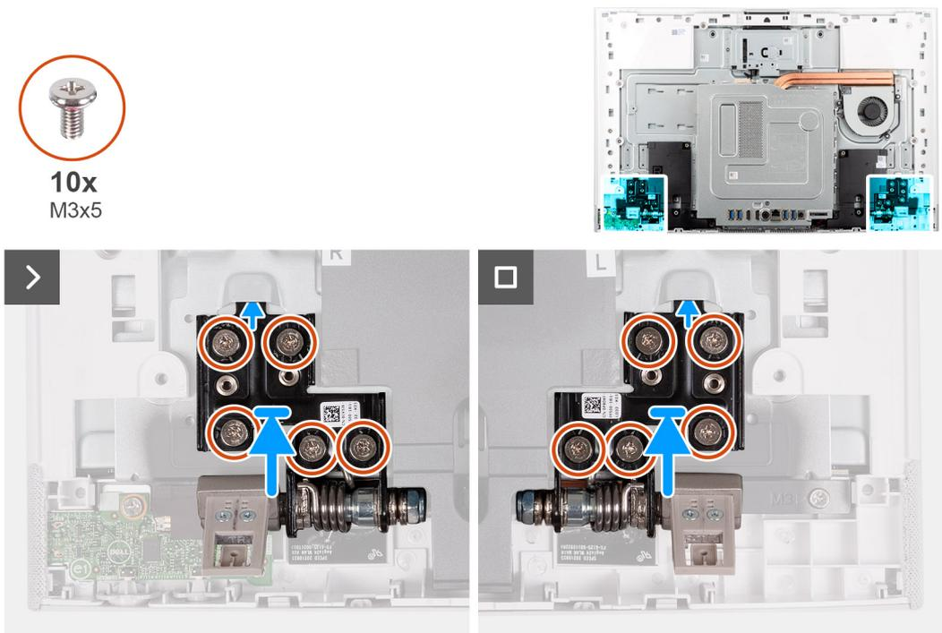
**Ilustración 26. Instalación de las bisagras del soporte**
