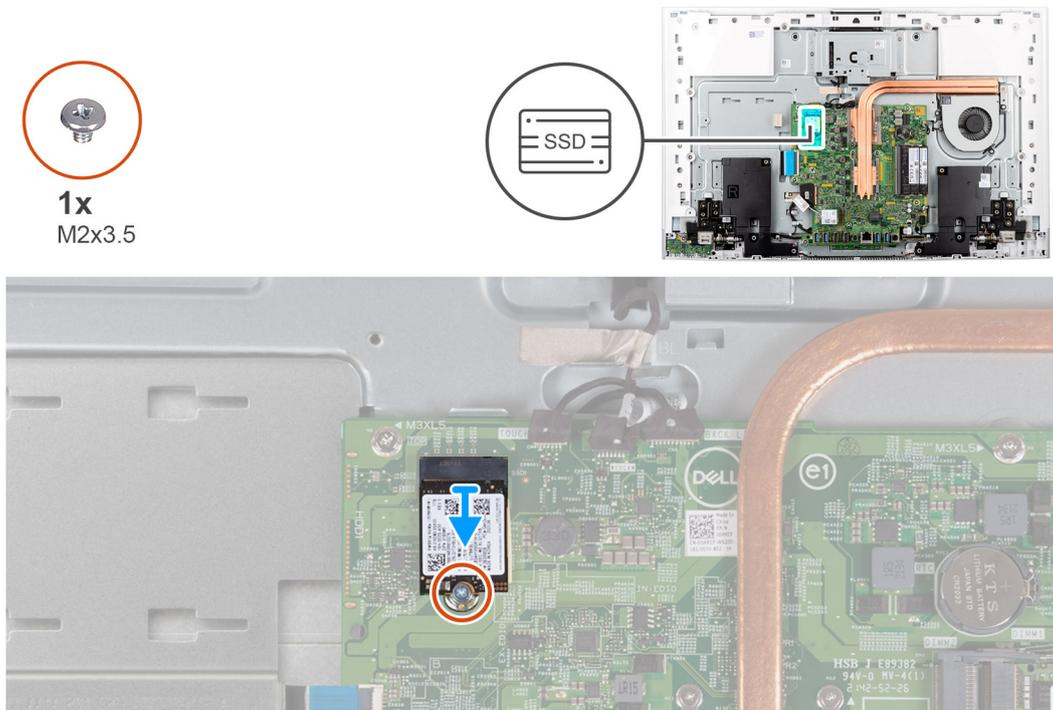
**Ilustración 29. Extracción de la unidad de estado sólido M.2 2230**
