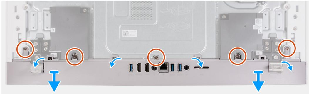
**Ilustración 23. Extracción de la cubierta de I/O**
