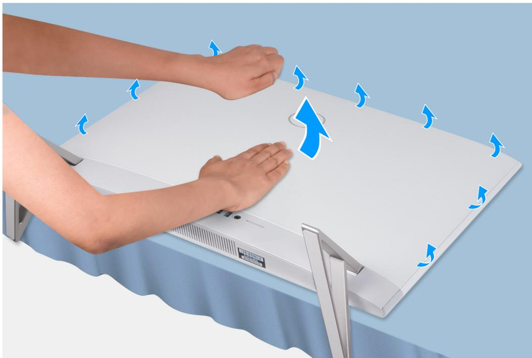
**Ilustración 21. Extracción de la cubierta posterior**
