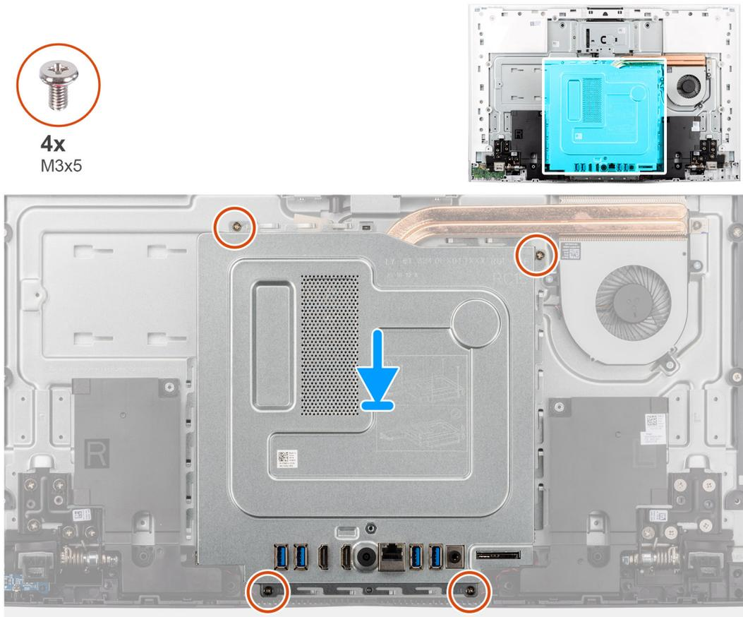
**Ilustración 28. Instalación del protector de la tarjeta madre**
