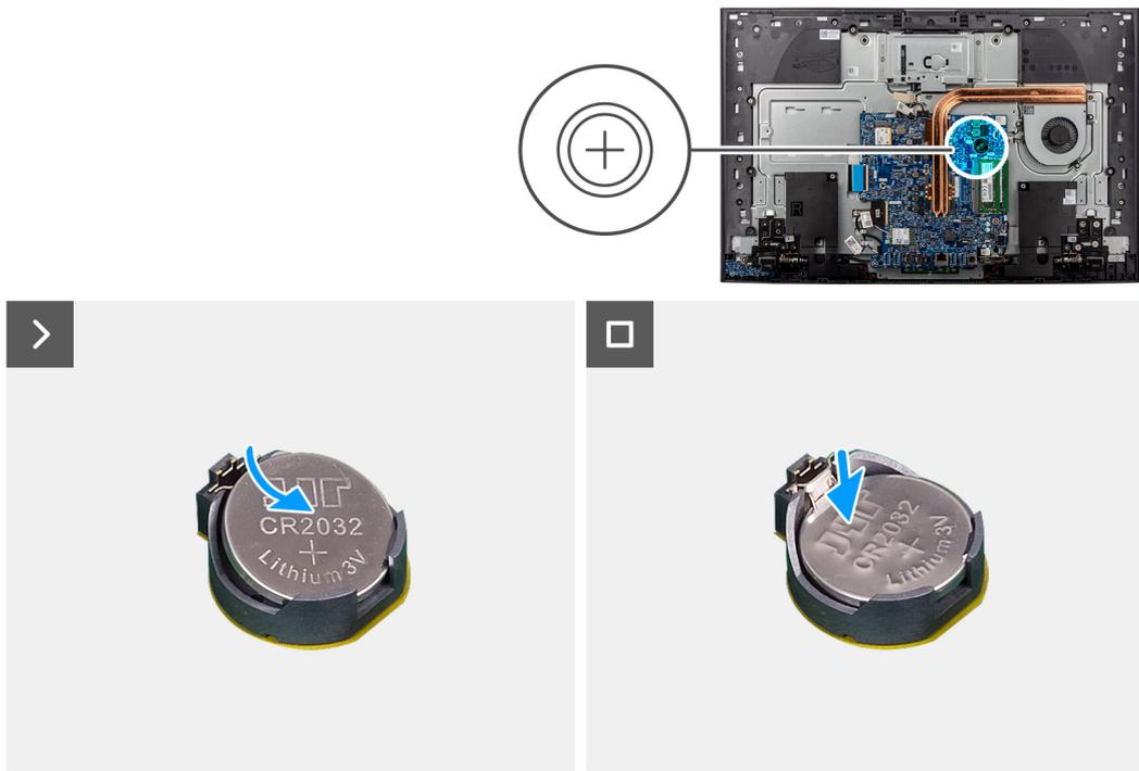
**Ilustración 42. Instalación de la batería de tipo botón**
