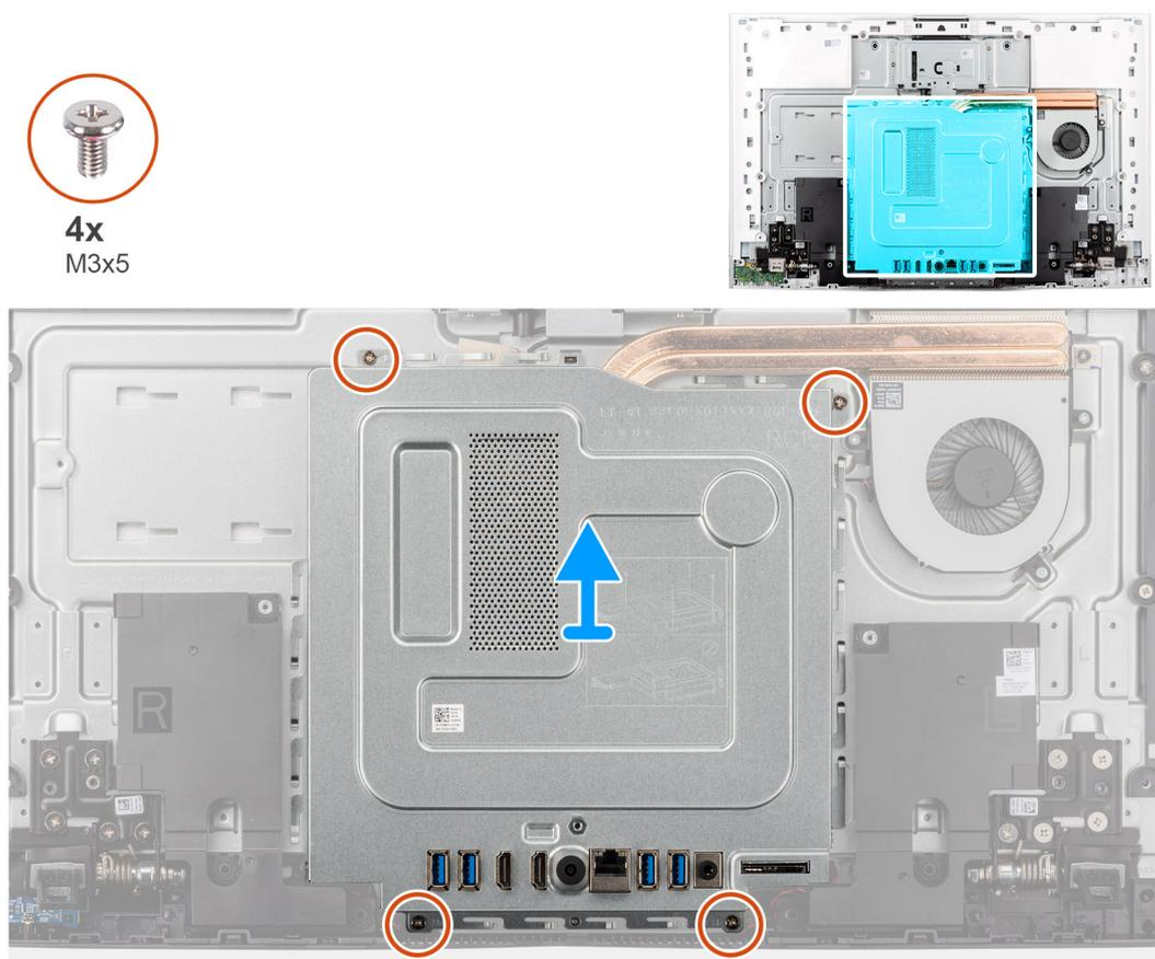
Ilustración 27. Extracción del protector de la tarjeta madre
