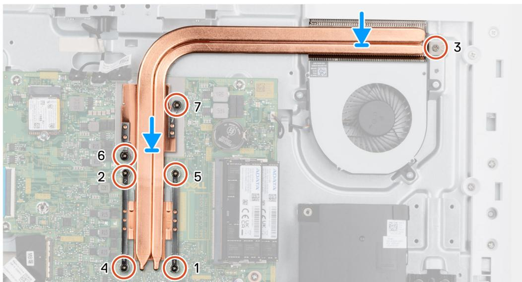
**Ilustración 46. Instalación del disipador de calor: discreto**
