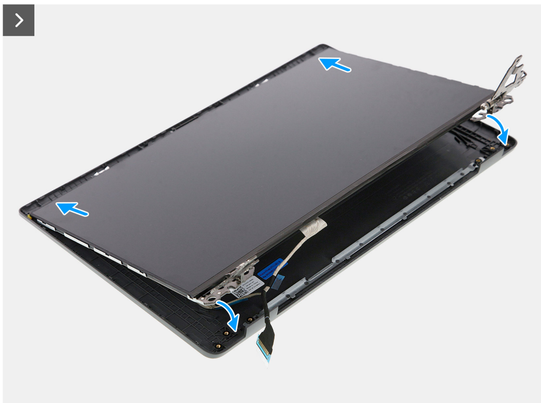
Ilustración 63. Instalación del panel de pantalla
