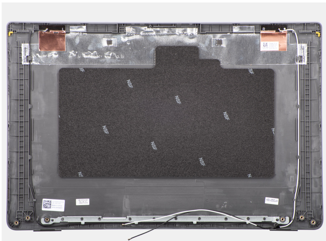
Ilustración 70. Extracción de la cubierta posterior de la pantalla
