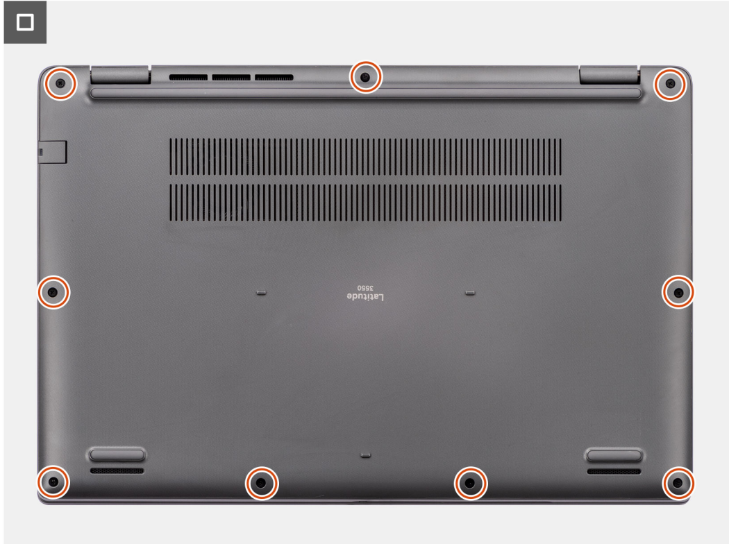
Ilustración 11. Instalación de la cubierta de la base
