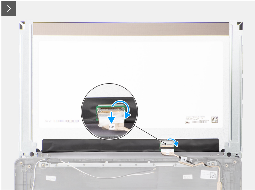
Ilustración 59. Extracción del panel de pantalla
