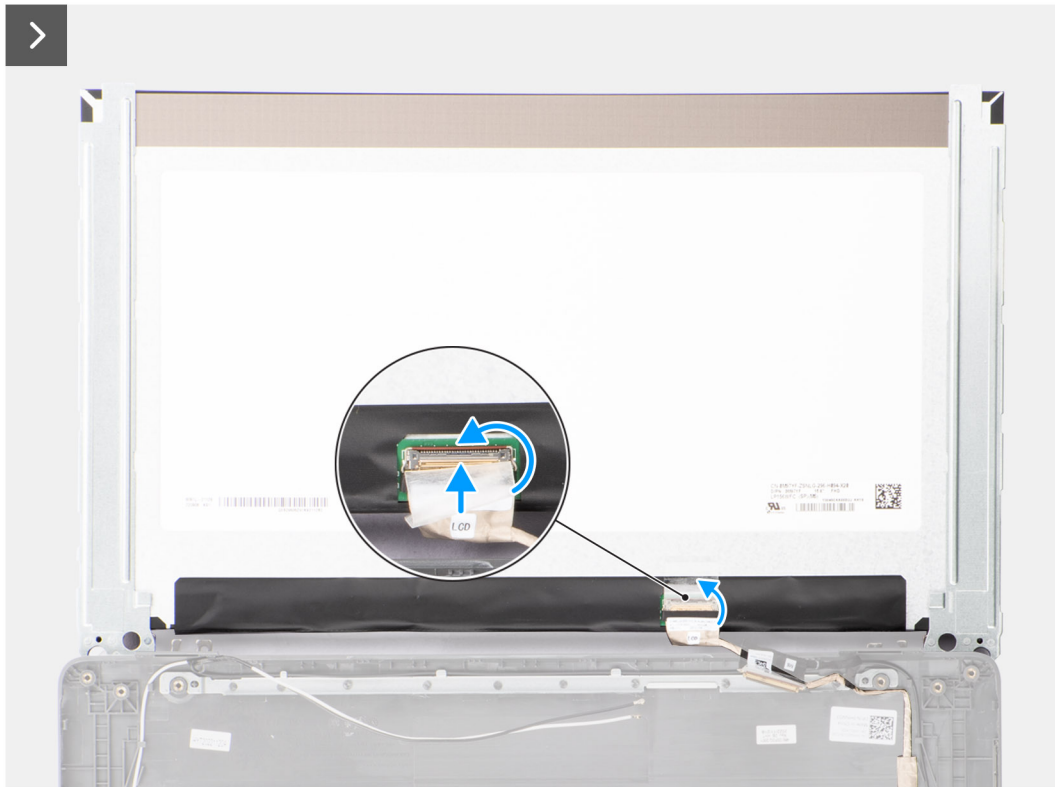
Ilustración 62. Instalación del panel de pantalla
