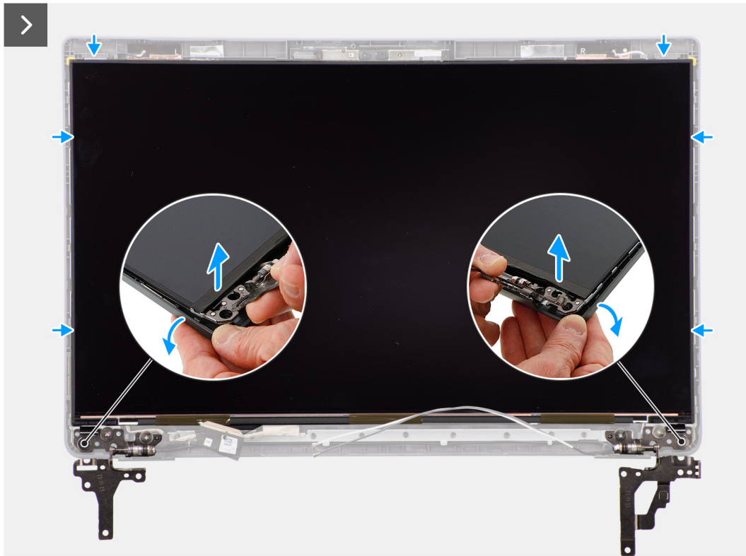
Ilustración 57. Extracción del panel de pantalla
