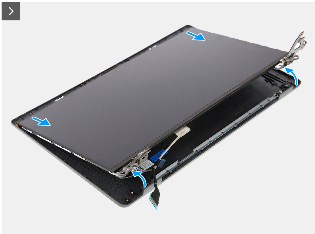
Ilustración 58. Extracción del panel de pantalla
