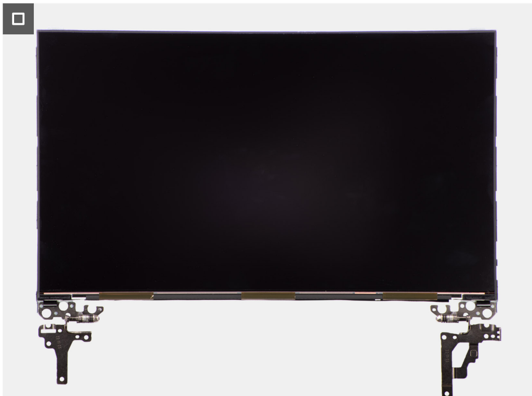
Ilustración 60. Extracción del panel de pantalla
